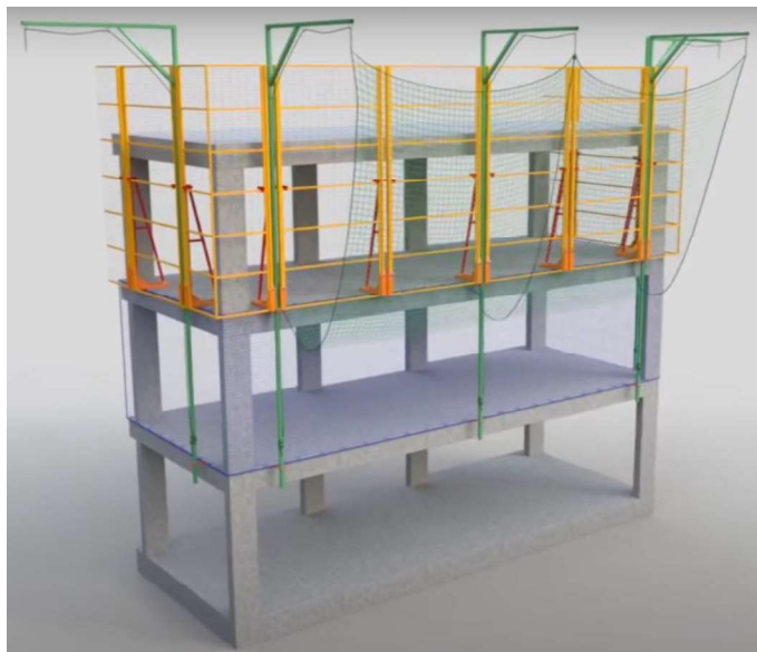
Figura 9: Edificação utilizando o sistema de proteção periférica deslizante
