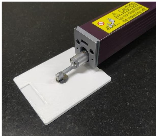
**Figura 4.2.** Rugosímetro portátil SurfTest SJ-210 e amostra posicionada no dispositivo de fixação.
