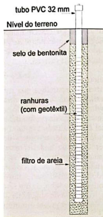
Figura 3: Medidor de nível d'água
