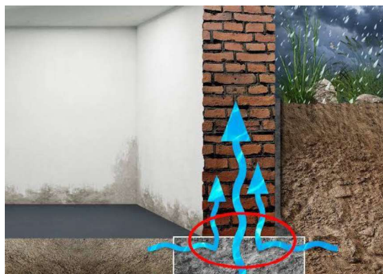
Figura 1: Infiltração de água por capilaridade
