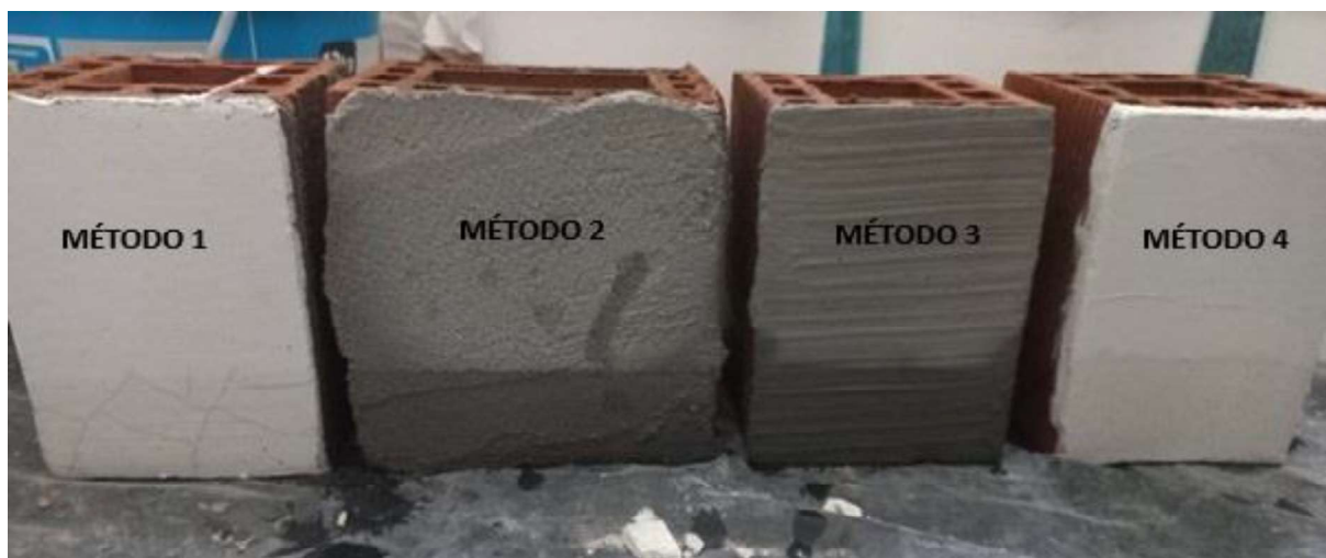
Figura 14: Teste de umidade e absorção em blocos cerâmicos
