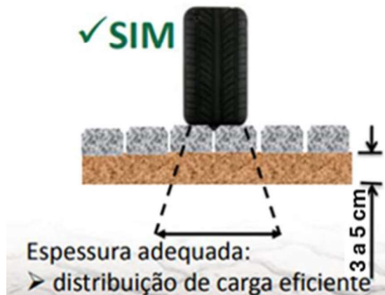
Figura 11: Camada de areia dimensionada corretamente
