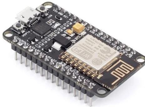
Fonte: Modificado de Eletrogate - "Módulo WiFi ESP8266 NodeMcu ESP-12E Amica" (2024).
