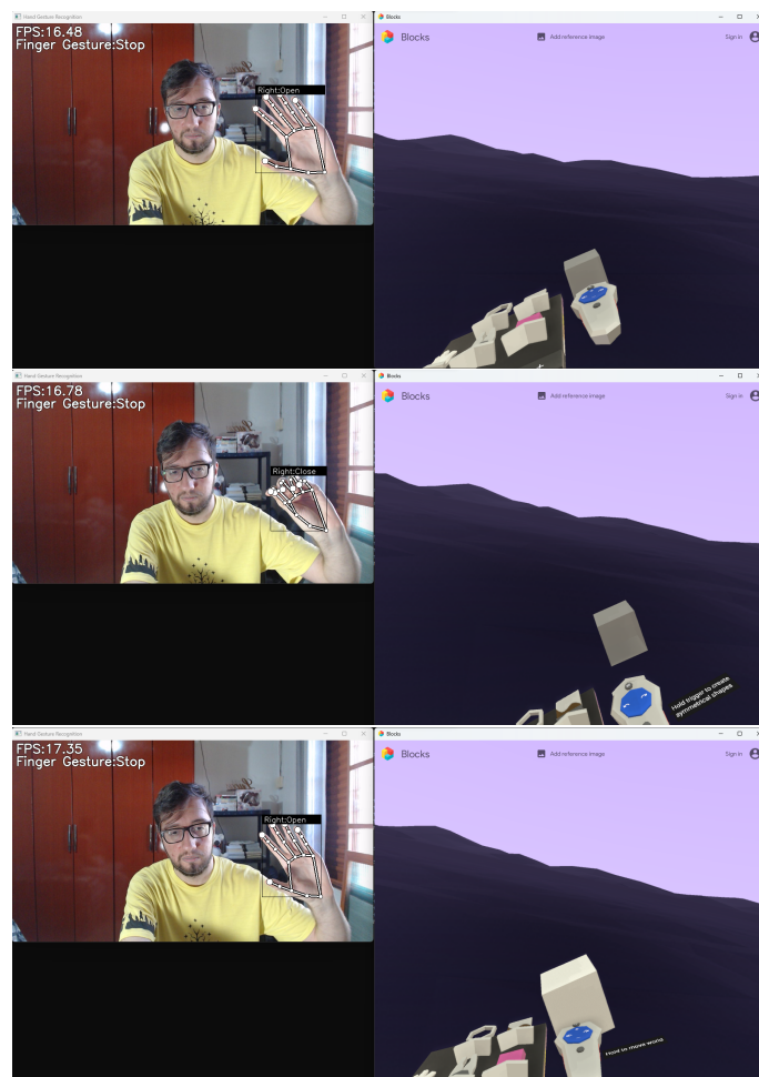
Figura 7. Exemplo de uso em que o gesto de fechar a mão é mapeado como gatilho para posicionar blocos no Google Blocks
