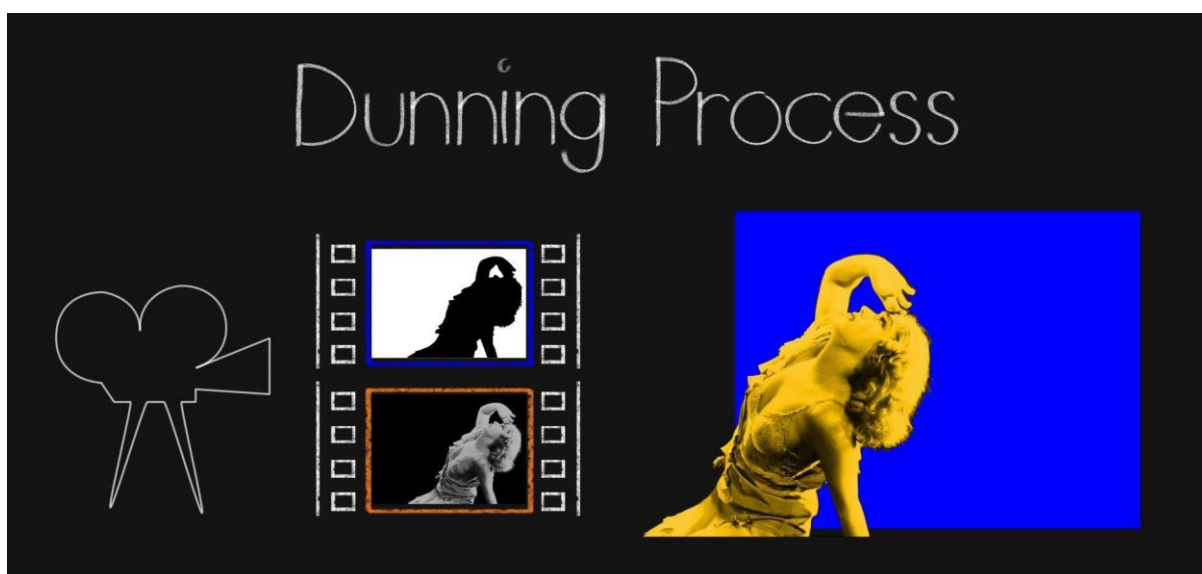
Figura 13 – Processo Dunning, separação das camadas por luzes coloridas
