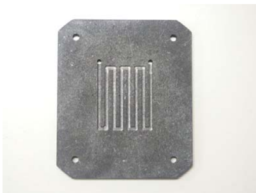
Figura 3.10: Eletrodo de grafite, com canais em forma de serpentina, utilizado no primeiro protótipo.
