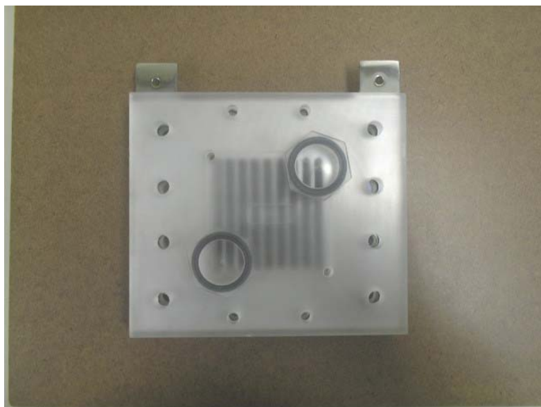
Figura 3.27: Colocação da placa de suporte externa no lado do ânodo.
