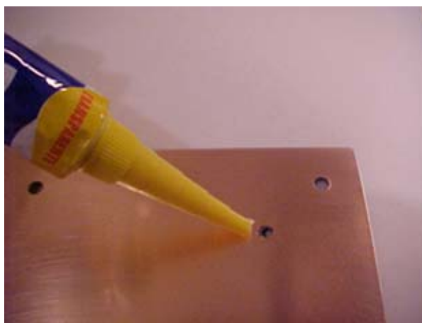
Figura 3.6: Aplicação de silicone líquido no primeiro protótipo.
