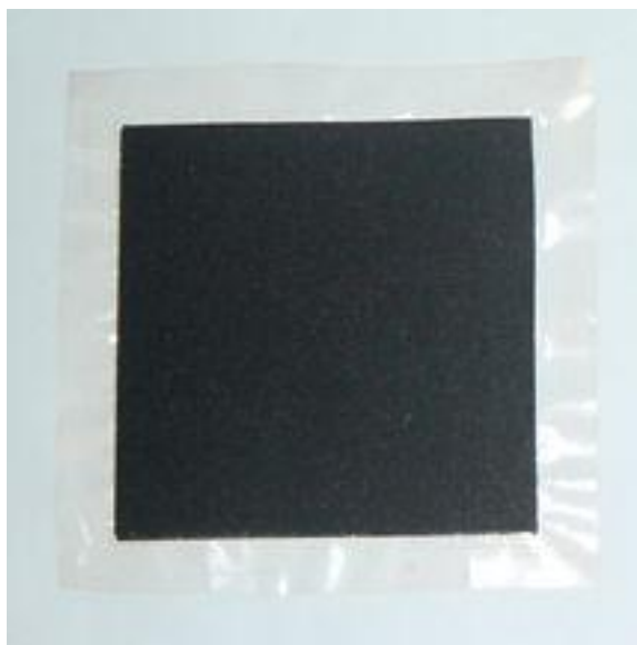
Figura 2.2: O MEA (Membrane Electrode Assembly).
