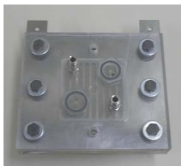
Figura 3.15: Segundo protótipo: seis parafusos para montagem.
