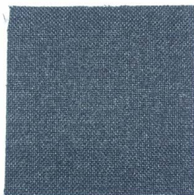
Figura 2.4: Eletrodo do MEA, constituído de tecido de carbono, no qual é implementada a camada GDL.
