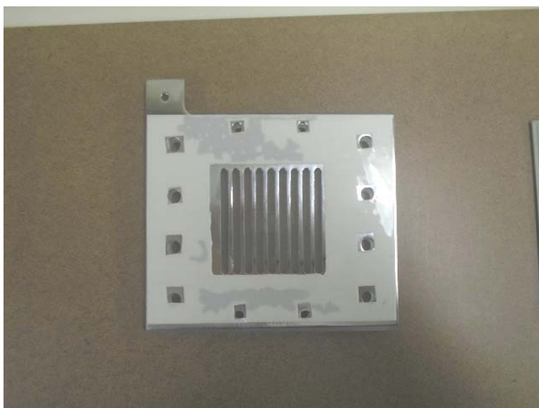
Figura 3.24: Colocação de junta de silicone.
