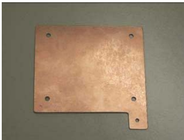
Figura 3.4: Placas de contato elétrico de cobre utilizadas no primeiro protótipo.
