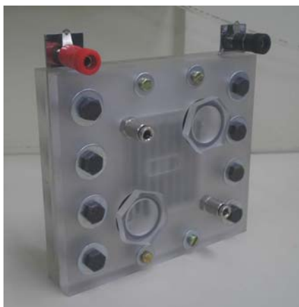
Figura 3.3: Montagem final do terceiro protótipo de célula a combustível PEM implementado na PUCRS no ano de 2006.
