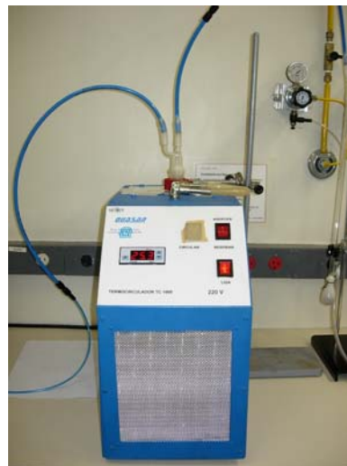
Figura 4.3: Termocirculador marca Quasar (modelo TC100) para aquecer o gás hidrogênio e favorecer a sua umidificação.
