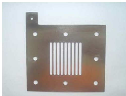
Figura 3.11: Eletrodo de aço inoxidável, com canais paralelos, utilizado no segundo e terceiro protótipos.
