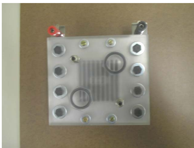
Figura 3.28: Colocação das arruelas e porcas Montagem das conexões de engate rápido.
