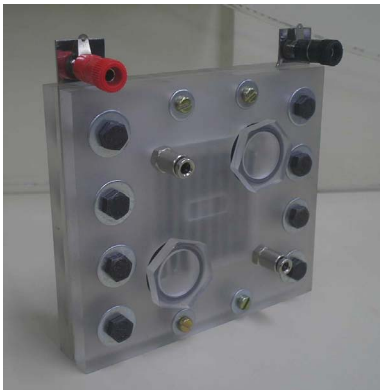
Figura 3.32: Montagem final do terceiro protótipo de célula a combustível PEM implementada na PUCRS.
