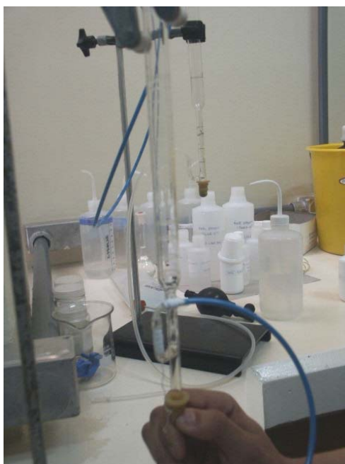
Figura 4.1: Bolhmetro, dispositivo utilizado para medir vazão do gás hidrogênio ou oxigênio.
