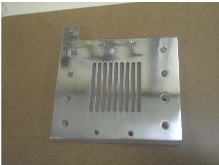
Figura 3.23: Colocação do eletrodo no lado cátodo.
