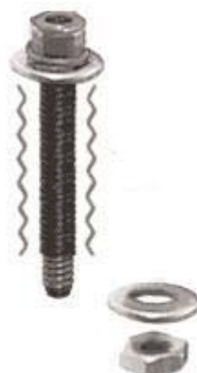
Figura 3.18: Aquecimento para contração do isolante termo-retrátil.
