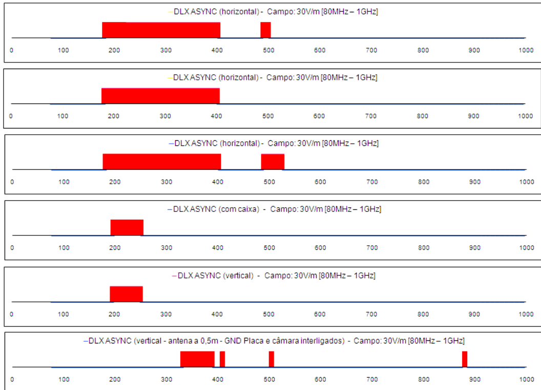
Figura 76: Gráfico de ocorrência de falhas nos ensaios de interferência eletromagnética irradiada (DLX assíncrono).
