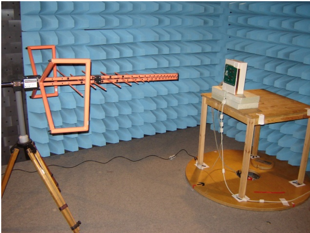
Figura 73: Configuração dos ensaios de interferência eletromagnética irradiada.
