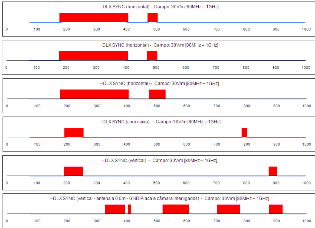
Figura 75: Gráfico de ocorrência de falhas nos ensaios de interferência eletromagnética irradiada (DLX síncrono).
