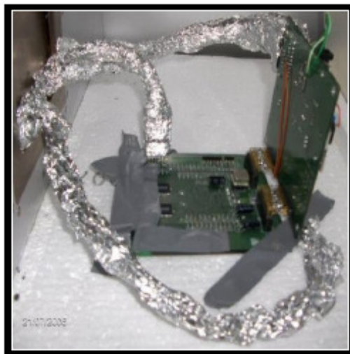
Figura 8.11 – DUT, mostrando o detalhe da placa inserida dentro da Célula (PICCOLI, 2006).
