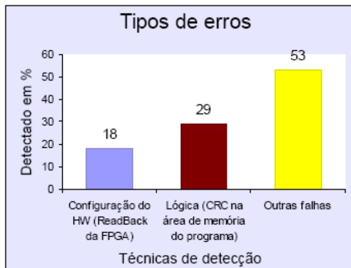
Figura 8.16 - Tipos de erros detectados utilizando o algoritmo gerador de números primos (PICCOLI, 2006).
