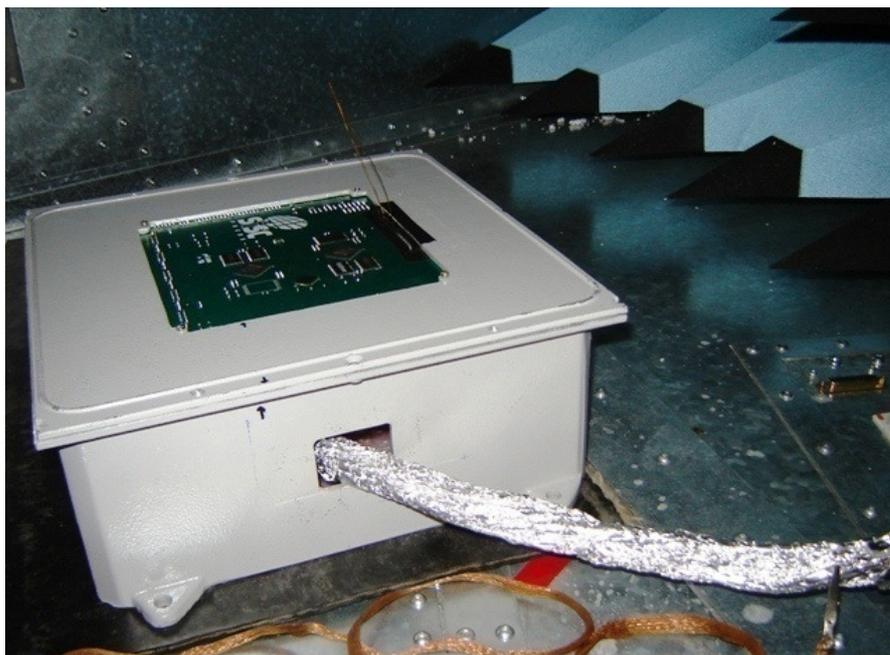
Figura 9.6 - Plataforma de testes e caixa metálica inseridas na célula TEM.
