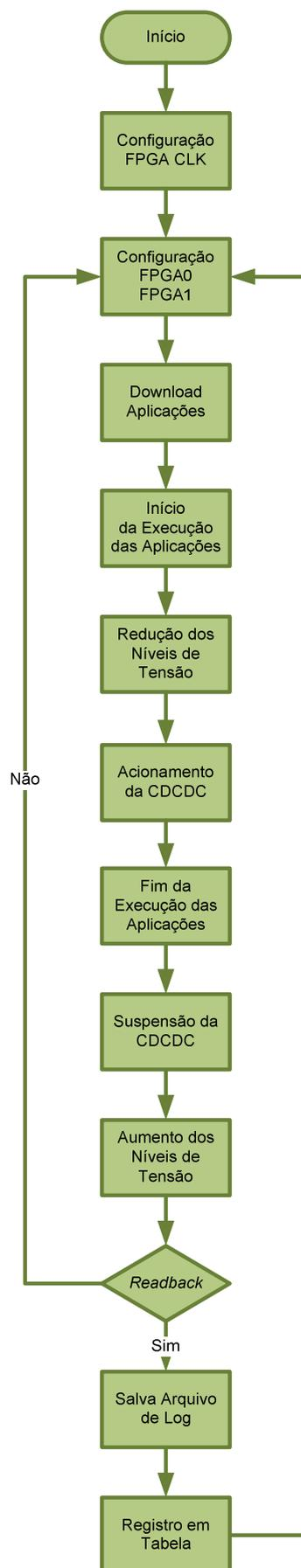
Figura 9.3 - Seqüência de procedimentos do teste de redução de tensão de alimentação.
