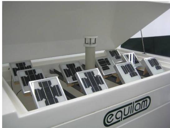
Figura 3.15. Câmara de corrosão com as amostras antes do ensaio.
