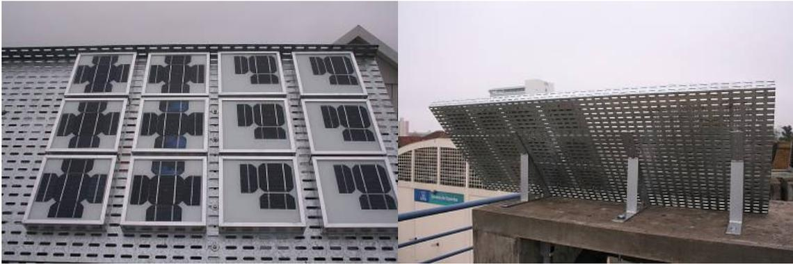
Figura 3.22. Protótipos A e B instalados a 48° de inclinação horizontal, voltados para o norte, em teste de exposição à condições externas.
