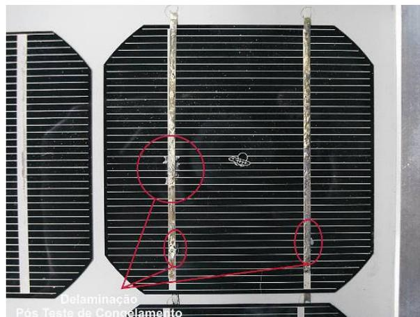
Figura 3.25. Delaminação pontual na amostra 24, protótipo A.
