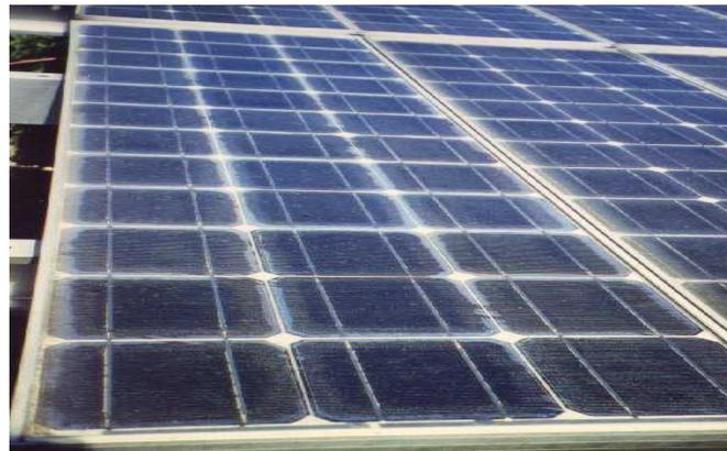
Figura 2.15. Delaminação em módulos fotovoltaicos registrados no sistema interligado do Ministério Federal da Economia em Berlim, Alemanha [24].
