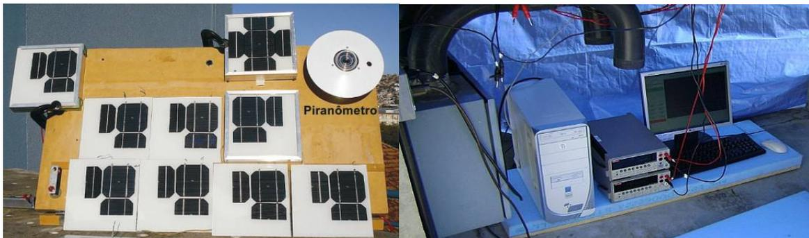
Figura 3.9. Caracterização elétrica dos protótipos A e B mostrando a plataforma, os protótipos e os equipamentos utilizados.
