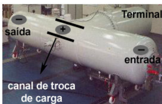
Figura 17 Foto do acelerador de partículas Tandetron da UFRGS, indicando a posição do “stripper”, local onde ocorre a troca de carga (modificado). Fonte: www.if.ufrgs.br (acesso em 20/05/06).
