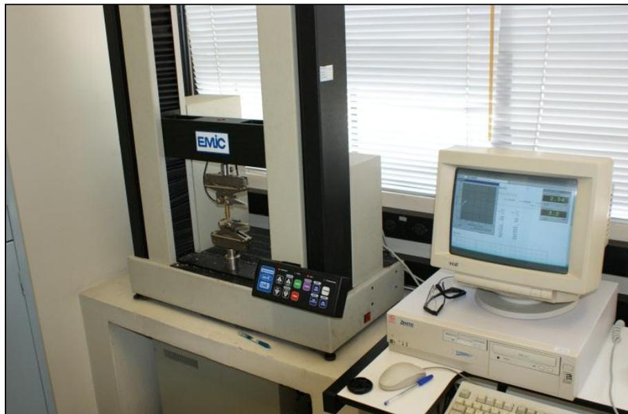
Figura 4.11. Teste de tração (pull-out) sendo realizado na máquina de testes universal (EMIC DL-2000®) e o computador que mostra a curva de tensão-deformação.
