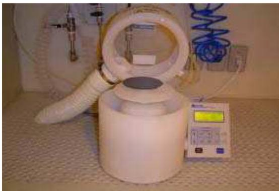
Figura 4.3. Equipamento denominado *spinner*, utilizado para a deposição de resina.
