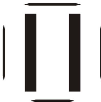
Figura 4.21. Desenho da máscara com as barras coletoras posteriores de 10 mm de largura.
