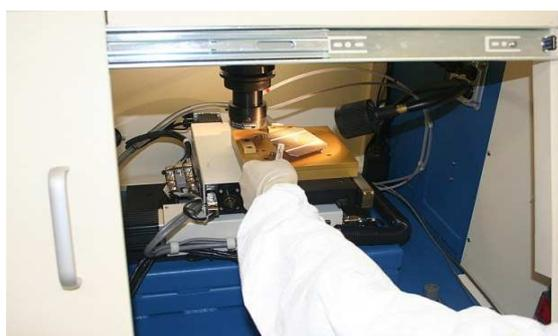
Figura 4.11. Equipamento utilizado para realizar o corte das bordas das células solares.
