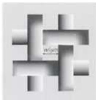
Figura 4.7. Desenho da malha da máscara de serigrafia.
