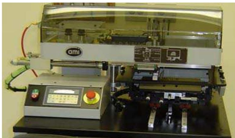
Figura 4.6. *Screen-printer* utilizada na serigrafia.
