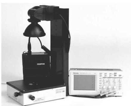
Figura 4.14. Equipamento denominado WCT utilizado para medição do tempo de vida dos portadores de carga minoritários.
