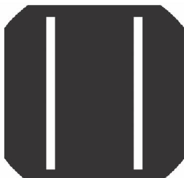
Figura 4.29. (a) Desenho da máscara com barras coletoras posteriores de 3,8 mm de largura.
