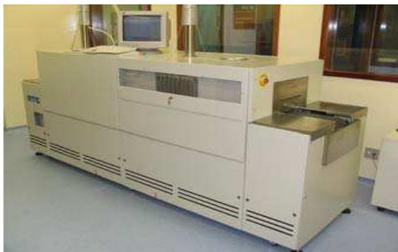
Figura 4.9. Forno de esteira usado na secagem e queima das pastas de Al, de Ag/Al e de Ag.
