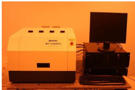
Figura 4.15. Equipamento WT-2000PV para a medição do tempo de vida dos portadores de carga minoritários com a técnica  $\mu$ -PCD e com a técnica LBIC.
