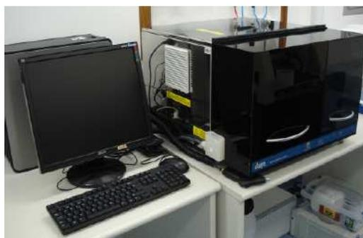
Figura 4.16. Equipamento Wafer Profiler CVP21 utilizado na obtenção de perfil de dopagem de fósforo.
