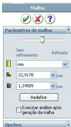
Figura 42 – Controle do tamanho de elemento a ser criado na malha computacional.
