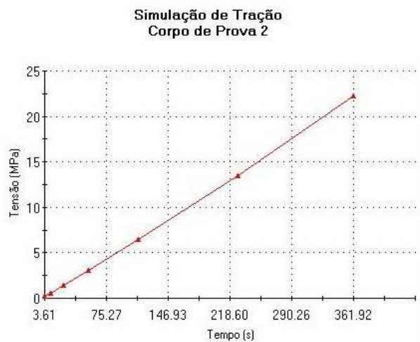
Figura 94 – Gráfico de tensão suportada em função do tempo para o segundo corpo de prova.
