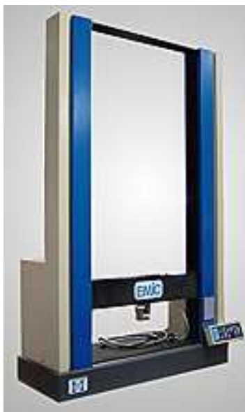
Figura 48 – Máquina para ensaios mecânicos de polímeros EMIC DL 2000 [EMIC, 2007].
