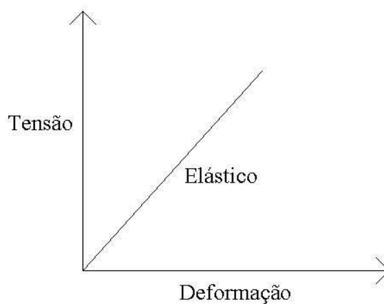
Figura 25 – Modelo linear-elástico do material [CosmosWorks, 2005].
