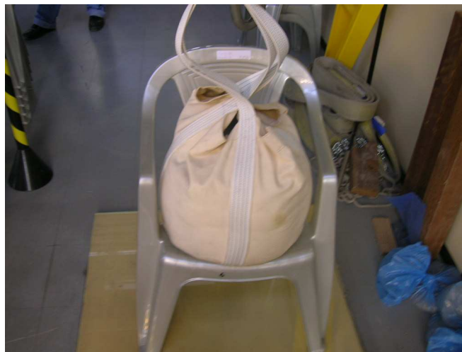
Figura 79 – Ensaio estático da cadeira plástica tipo monobloco.
