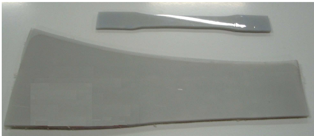
Figura 45 – Encosto da cadeira e corpo de prova usinado a partir do mesmo.
