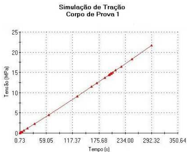
Figura 92– Gráfico de tensão suportada em função do tempo para o primeiro corpo de prova.
