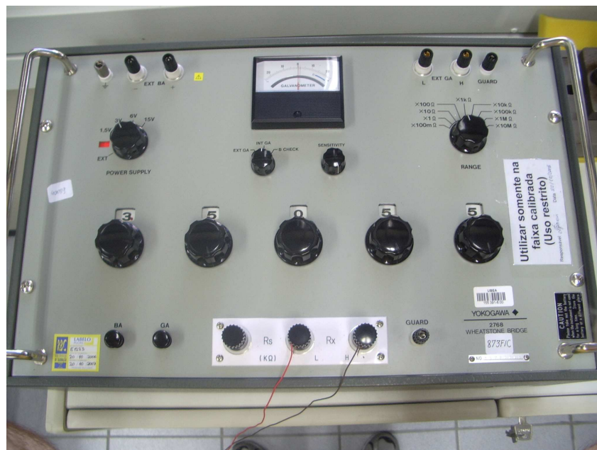
Figura 61 – Ponte de Wheatstone utilizada para medição das resistências.
