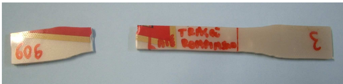
Figura 84 – Corpo de prova fraturado devido à presença de um defeito de preenchimento.
