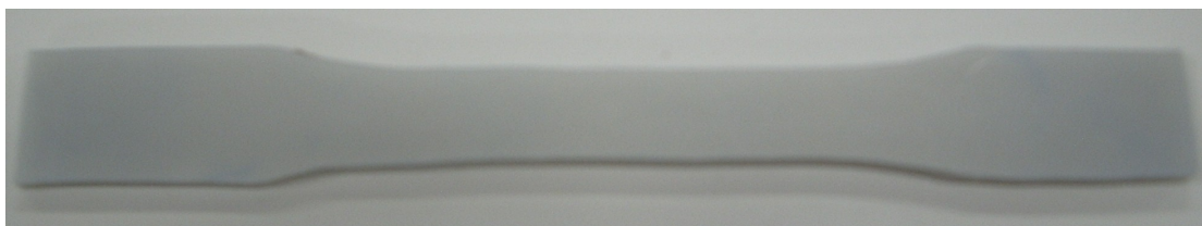
Figura 46 – Corpo de prova utilizado para os ensaios de tração.
