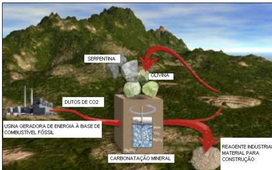
Figura 3.4. Planta de carbonatação idealizada. Adaptado de Bauer, 2001.
