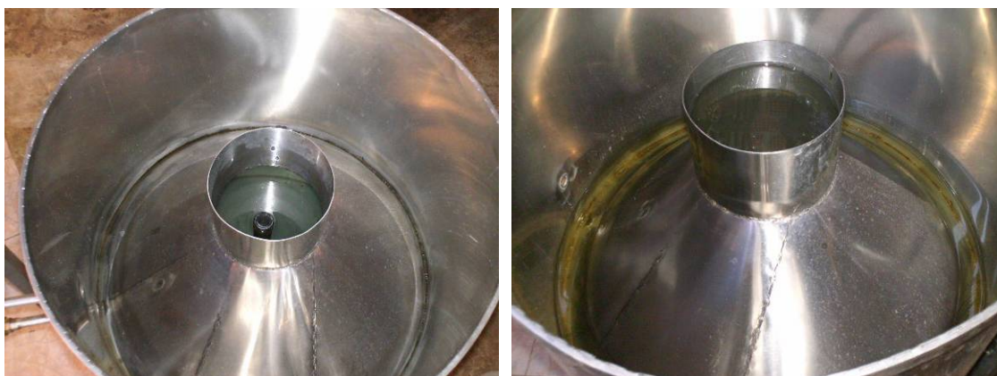
Figura 4.6. Vaso separador da unidade industrial - vaso florentino.
