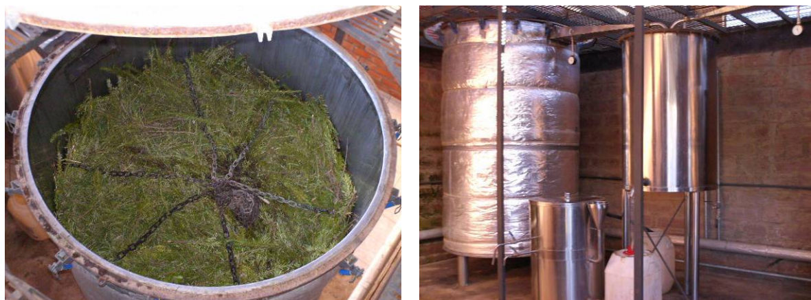
Figura 4.4. Vasos de extração da unidade industrial.
