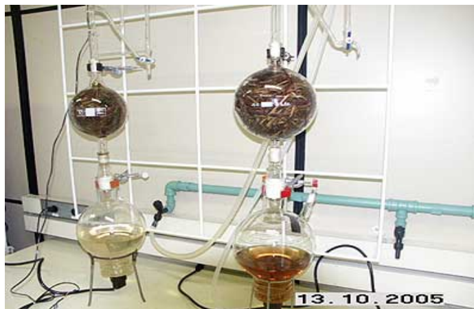
Figura 4.1. Unidade Laboratorial de Destilação por Arraste a Vapor
