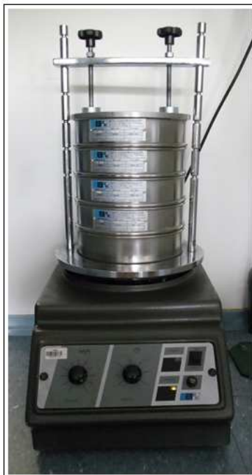
Figura 4.3. Processo de peneiramento da amostra.
