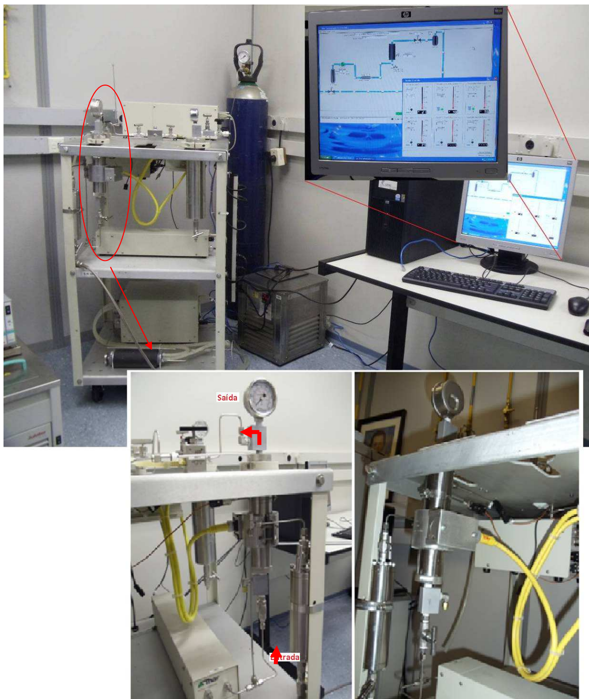
Figura 4.5. Sistema reacional com as conexões dos controles de temperatura. Software utilizado para controle computacional da temperatura e da pressão no interior do reator (com detalhe da janela do software). As figuras na parte inferior (em detalhe) mostram a frente e o verso das conexões ao reator, as setas indicam a entrada e a saída de gás no reator (figura inferior esquerda).
