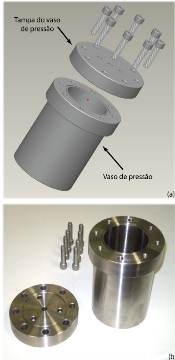
Figura 4.1. Desenho do projeto do vaso de pressão do reator (a) e fotografia do reator em aço inoxidável AISI 304 depois do processo de usinagem (b).
