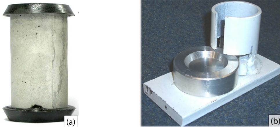
Figura 4.11. Fotografia do corpo-de-prova pronto para ensaio de compressão após o capeamento (a) e fotografia do dispositivo para fazer o capeamento dos corpos-de-prova (b).
