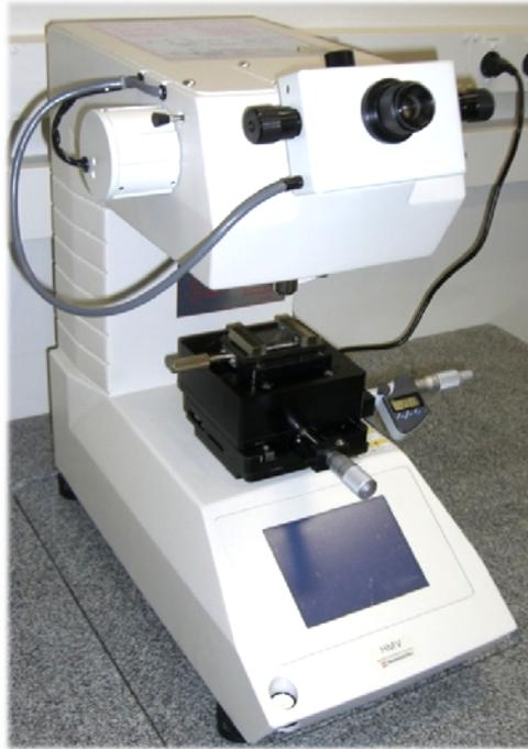
Figura 4.10. Fotografia do Microdurômetro HMV-2T da marca Shimadzu.
