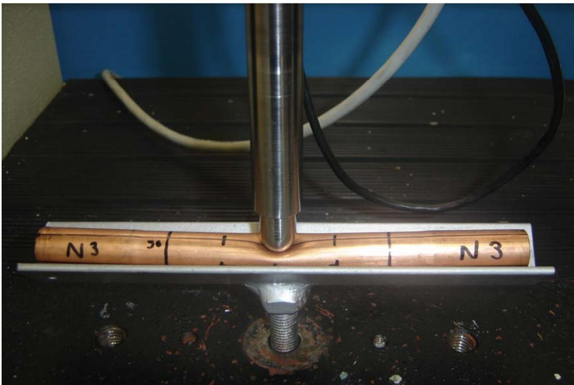
Figura 5.67. Contato entre o punção indentador e a amostra do tubo.
