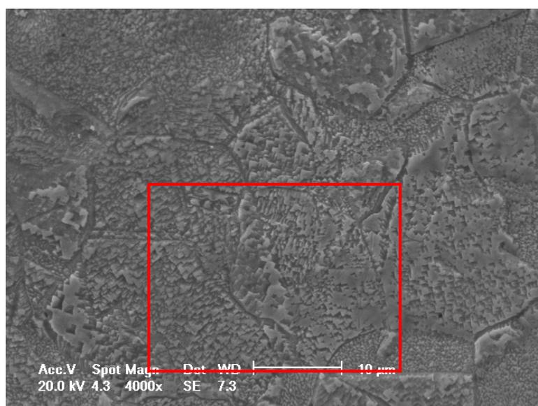
Figura 5.24. Amostra transversal do tubo danificado comercialmente, modo SE, aumento 4000 vezes (região em destaque na Figura 5.23).
