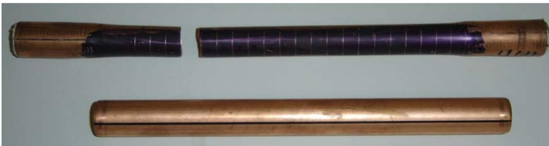
Figura 5.65. Corpo de prova rompido após o ensaio de tração e corpo de prova original.
