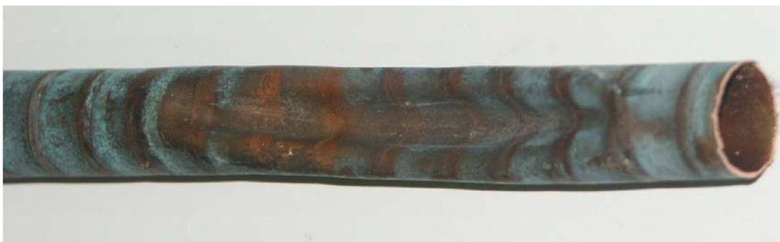
Figura 1.2. Tubo danificado apresentando uma depressão na sua curvatura.
