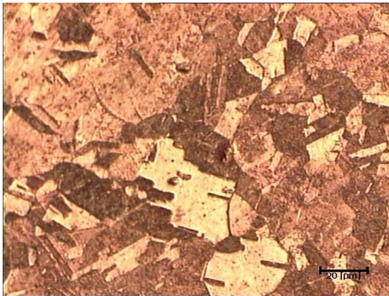
Figura 5.18. Amostra transversal do tubo danificado comercialmente, aumento de 500 vezes.
