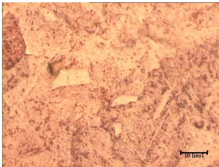
Figura 5.17. Amostra longitudinal do tubo danificado comercialmente, aumento de 1000 vezes.
