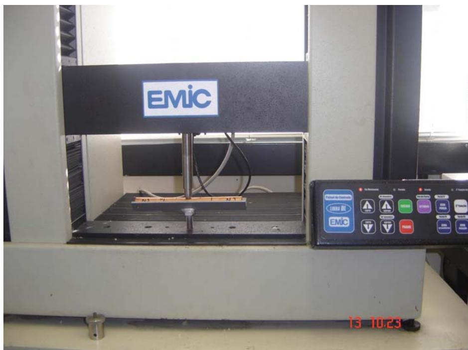
Figura 5.66. Ensaio de indentação do corpo de prova na base de 120°.
