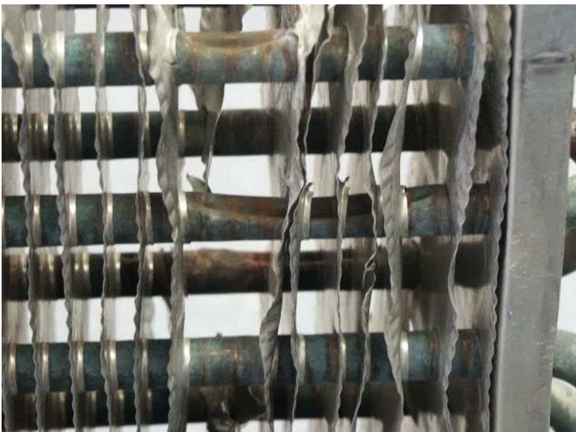
Figura 5.3. Área danificada do trocador de calor.
