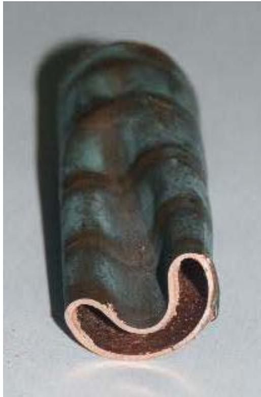
Figura 5.5. Corte transversal do tubo danificado.
