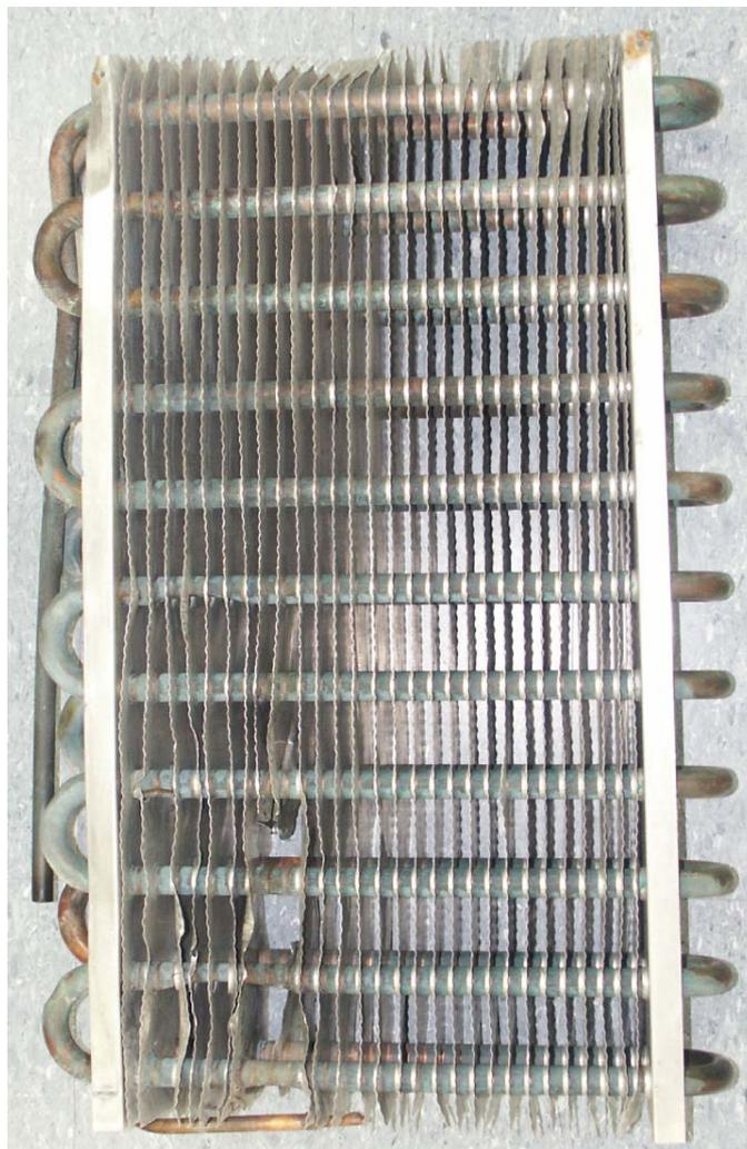
Figura 5.2. Trocador de calor danificado em uso.
