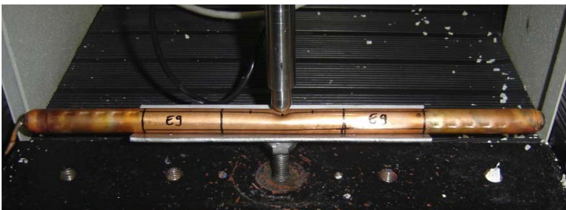
Figura 5.70. Tubo de cobre pressurizado ao final do ensaio.
