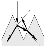
Figura 4-2. Trajetória da radiação solar em uma superfície de silício com texturação, para diminuir a refletância [7].
