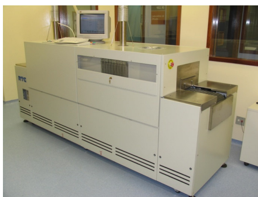
Figura 4-19. Foto do forno de difusão/queima de pastas de serigrafia.
