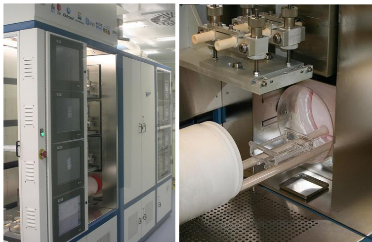
Figura 4-10. Forno de difusão convencional marca Tystar.
