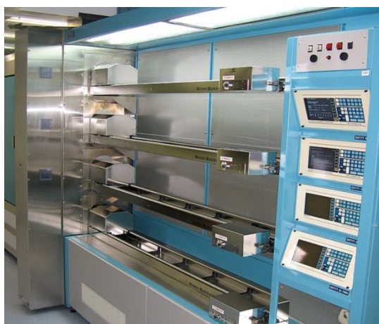
Figura 4-9. Forno de difusão convencional marca Bruce.
