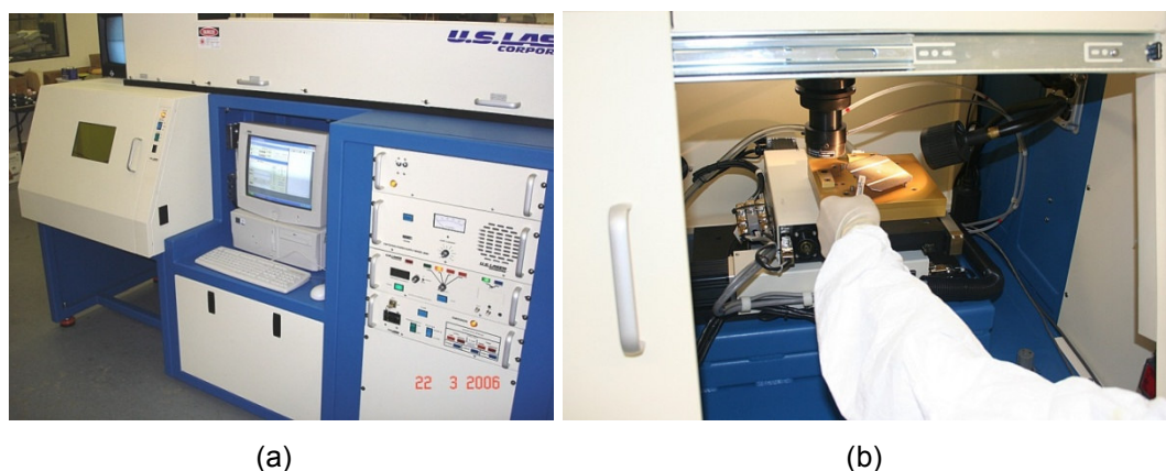
Figura 4-27. (a) Equipamento destinado à separação da região n^+ da p^+ nas bordas das células solares de silício e (b) detalhe interno do equipamento.
