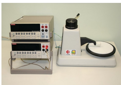
Figura 4-11. Equipamento com 4 pontas utilizado para o mapeamento da resistência de folha em lâminas de silício.
