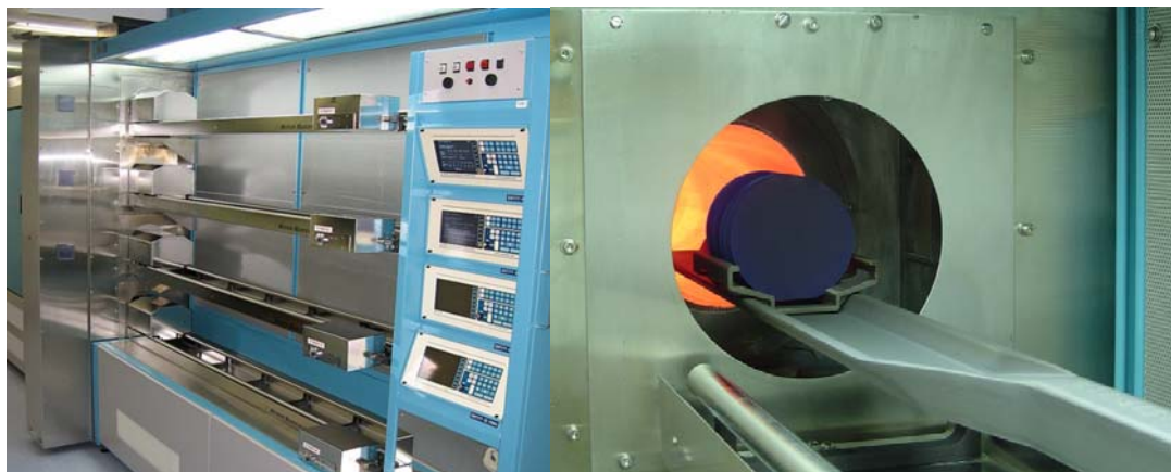
Figura 3.8. Forno de difusão convencional marca Bruce.
