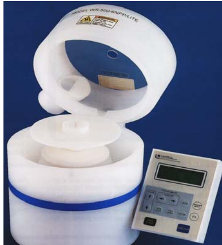
Figura 3.6. “Spinner” utilizado para a deposição dos dopantes líquidos com boro.
