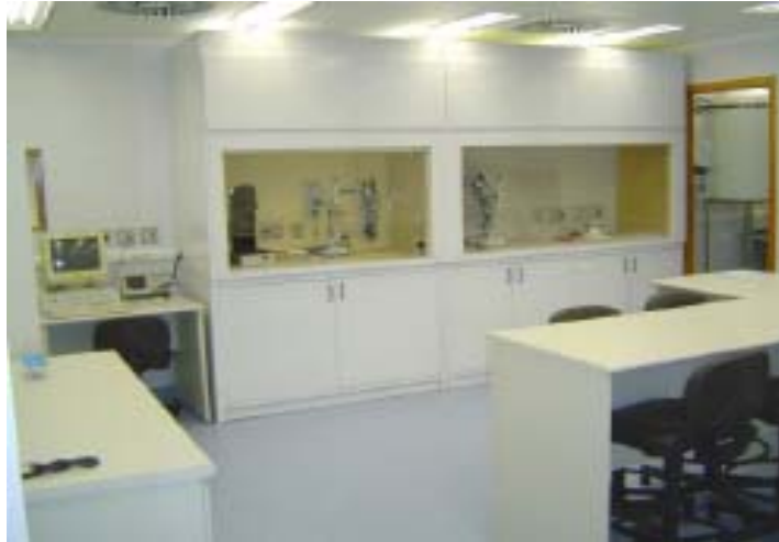
Figura 3.2. Capela de limpeza química RCA1, RCA2 e ataque químico CP4 realizados nas superfícies das lâminas de silício.
