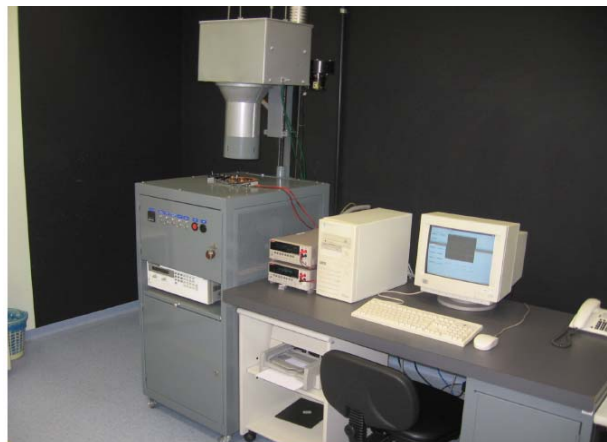
Figura 4.6. Equipamento utilizado para a medição da curva da corrente elétrica em função da tensão aplicada (I-V) sob condições padrão de 1000 \text{ W/m}^2 , espectro solar AM1,5G e temperatura das células de 25 \text{ }^\circ\text{C} .
