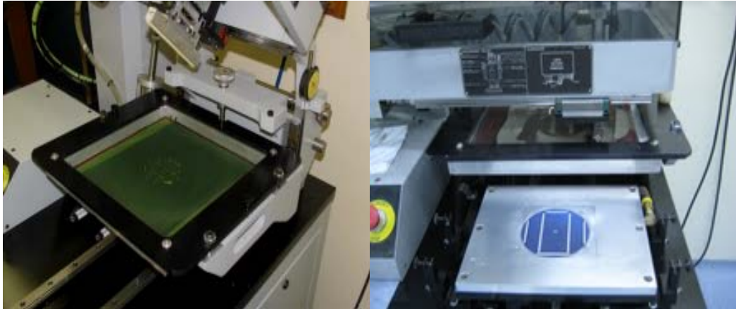
Figura 4.3. Equipamento de serigrafia ( screen printing ) utilizado na deposição de pastas metálicas.
