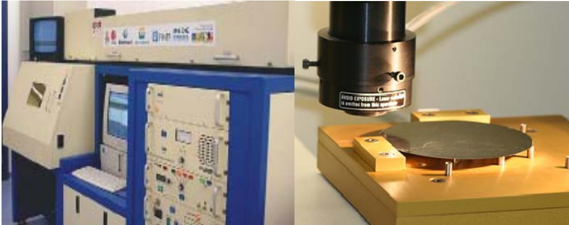
Figura 4.5. a) Equipamento de corte com radiação laser e b) lâmina de Si posicionada na mesa com movimentação X-Y.
