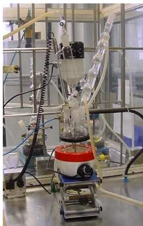
Figura 19: Reator utilizado na síntese dos poliuretanos.
