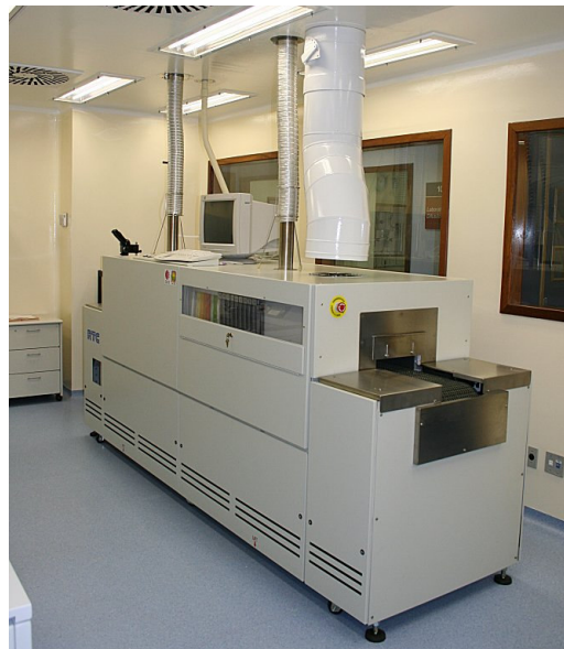
Figura 4.9. Forno de esteira instalado no Laboratório de Metais e Filmes do NT-Solar/PUCRS.
