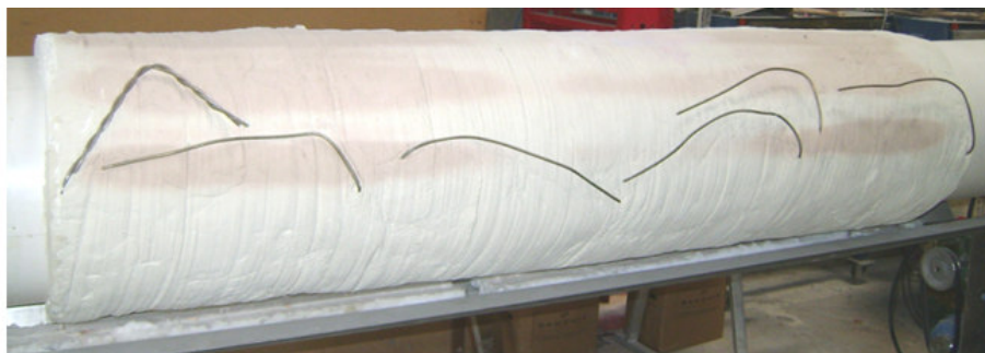
Figura 5.5. Conjunto de resistores recoberto por camadas de pasta cerâmica.
