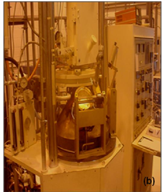
Figura 3.9. (a) Esquema de um equipamento para crescimento de cristais pelo método Czochralski e (b) Equipamento Czochralski do IKZ, Berlim.
