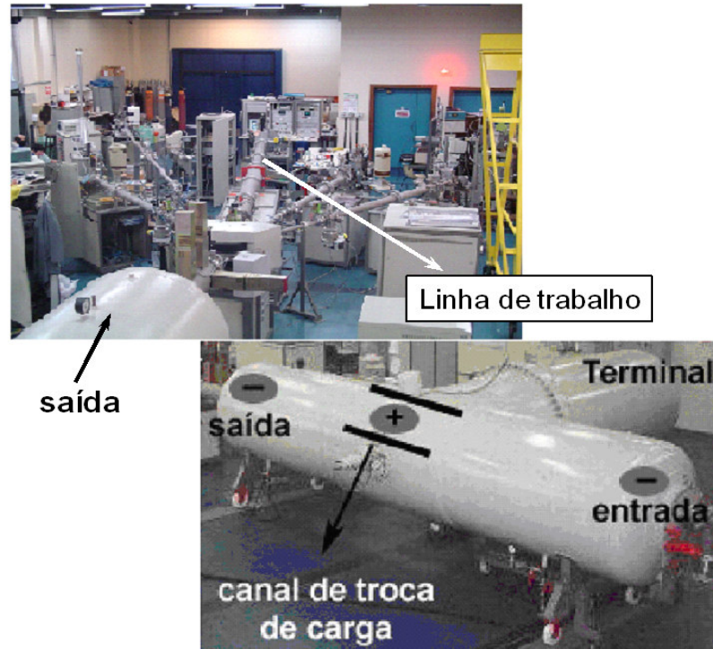
Figura 2.7. Foto do acelerador de partículas Tandatron da UFRGS, indicando a posição do “stripper” e a linha de trabalho utilizada.
