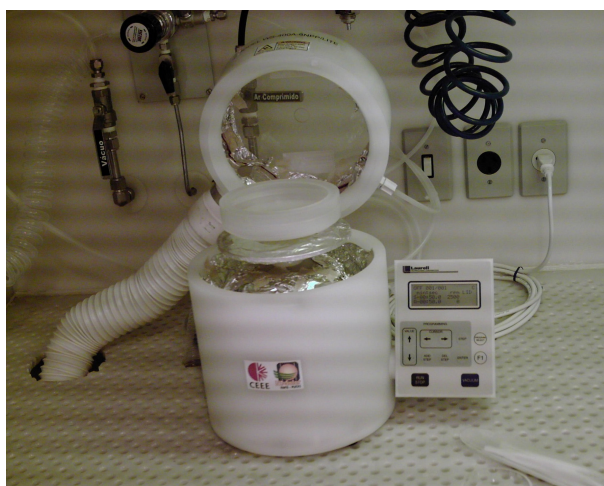
Figura 4.1 - Spinner utilizado para a deposição do dopante Phosphorus Film P509, fornecido pela Filmtronics.
