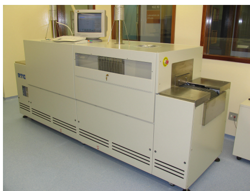
Figura 5.25 - Forno de infravermelho para recozimento da malha metálica.
