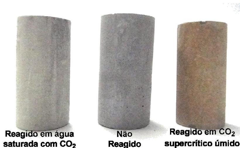
Figura 5.3. Comparativo entre superfície externa dos corpos de prova reagidos e não reagido com  $\text{CO}_2$ .
