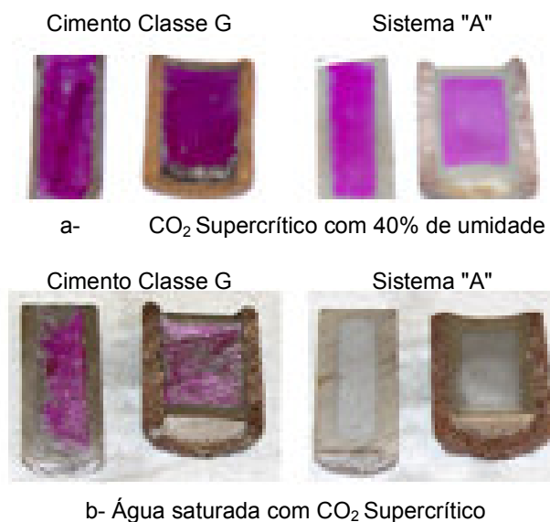
Figura 7-7 - Amostras, seccionadas e tratadas com fenolftaleína corante (exceto para o sistema de \text{CO}_2 supercrítico com 40% de umidade, o qual não foi tratado com fenolftaleína, após exposição ao \text{CO}_2 por 15 dias (Santra e Sweatman, 2011).
