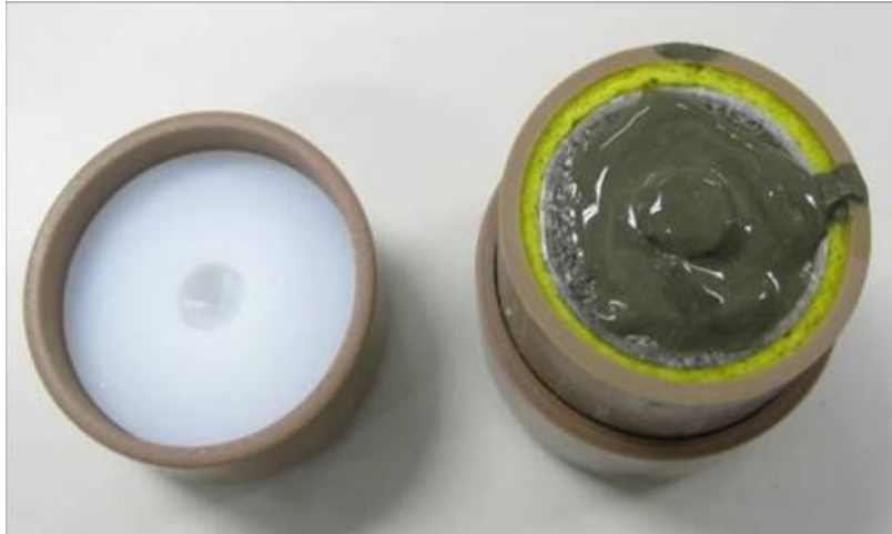
Figura 8-12 - Cimentação do espaço anular.
