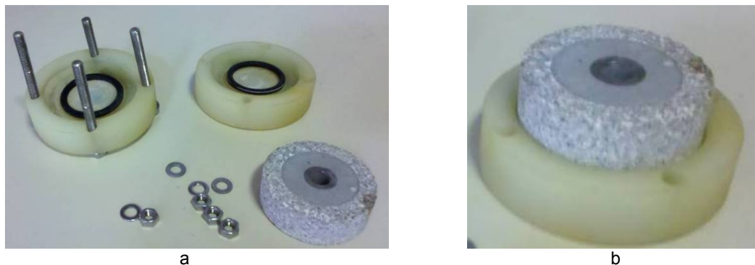
Figura 8-17 - Imagens ilustrando a montagem final do corpo de prova para os ensaios de degradação.
