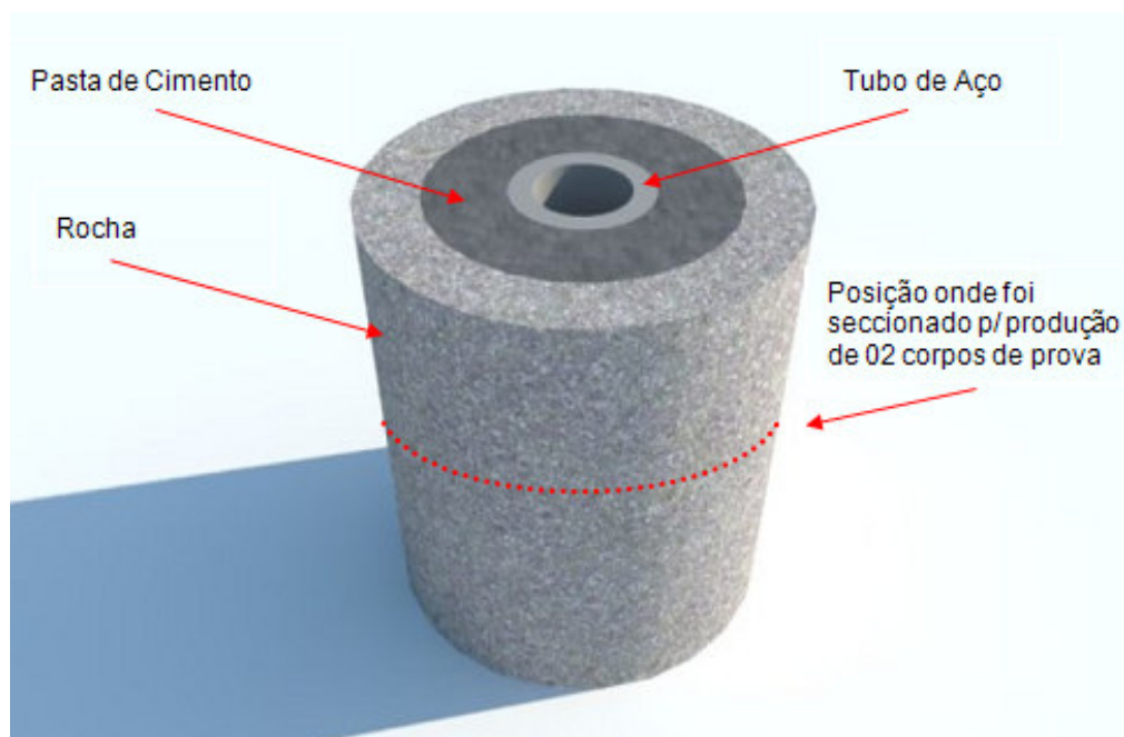
Figura 8-1 - Modelo do corpo de prova desenvolvido para os ensaios de degradação do cimento por CO 2 nas interfaces com a rocha e o tubo de aço.
