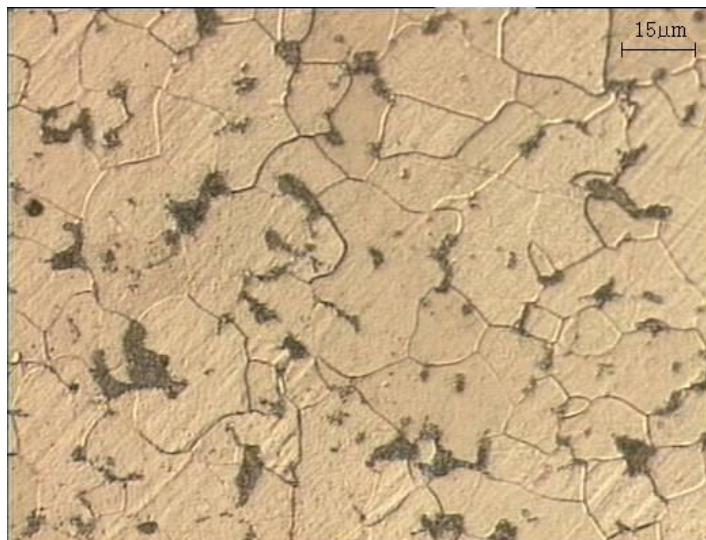
Figura 8-4 - Microestrutura do tubo de aço API 5L grau B evidenciando os grãos de ferrita (claros) e perlita (escuros). 500x.
