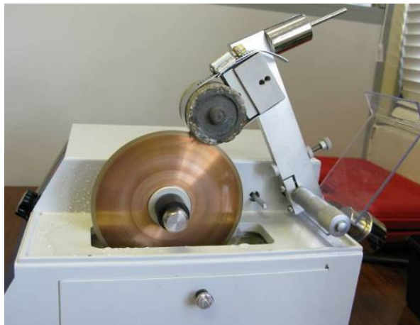
Figura 8-14 - Corte da face superior e inferior dos corpos-de-prova em serra de precisão para regularização da superfície.
