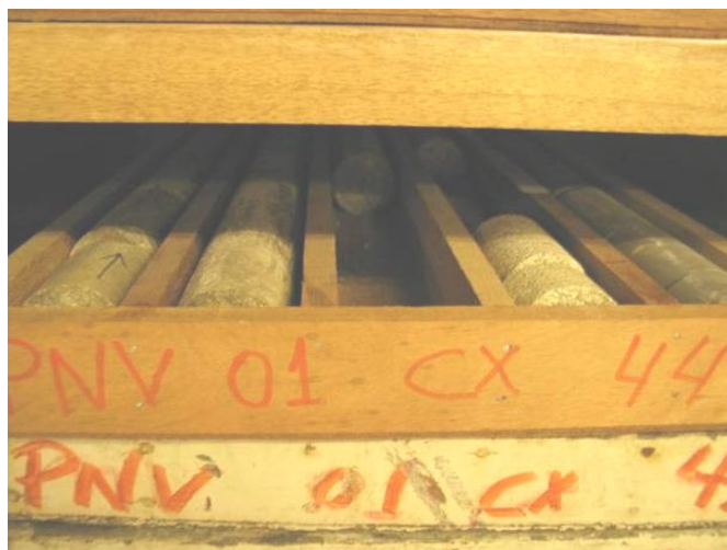
Figura 8-5 - Testemunhos de rocha arenito da Formação Rio Bonito (Bacia do Paraná).
