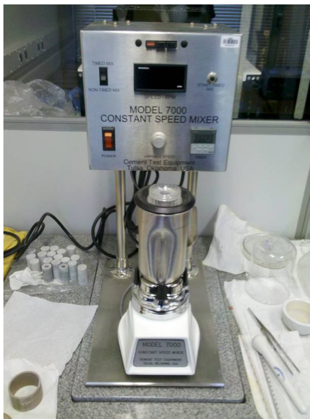
Figura 8-2 - Misturador utilizado para a elaboração das pastas de cimento.
