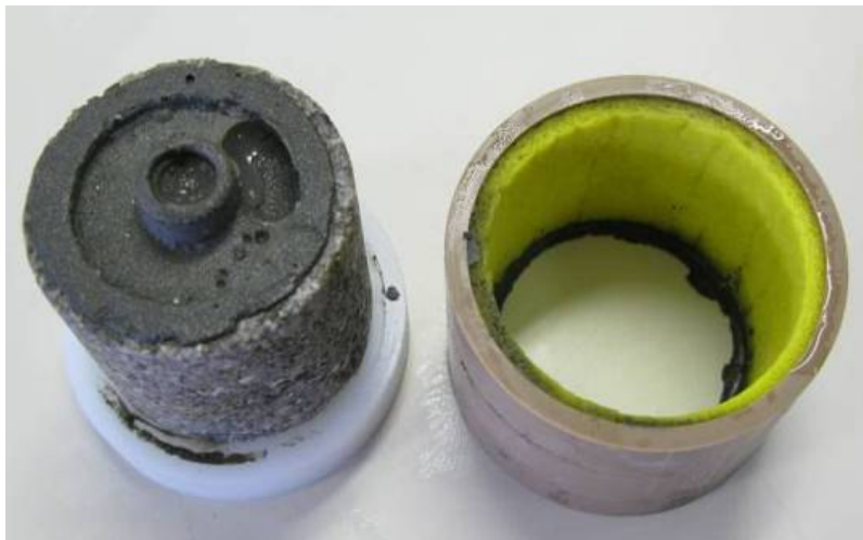
Figura 8-13 - Desmoldagem do corpo de prova após a cura térmica.
