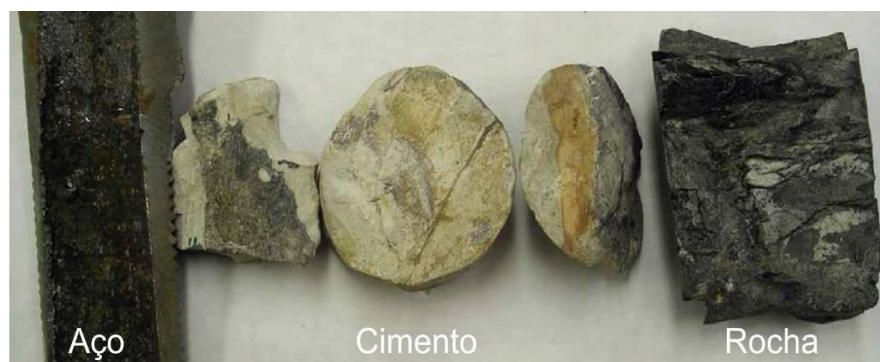
Figura 7-2 - Testemunho de pasta de cimento extraído de um poço da unidade de Sacroc no Texas, EUA, o qual foi exposto ao CO 2 supercrítico por 30 anos (Carey et al. , 2007).
