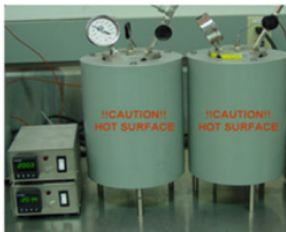
Figura 7-6 - Células de teste estático usados para a realização dos ensaios de degradação do cimento em presença de rocha com CO 2 supercrítico (Santra e Sweatman, 2011).
