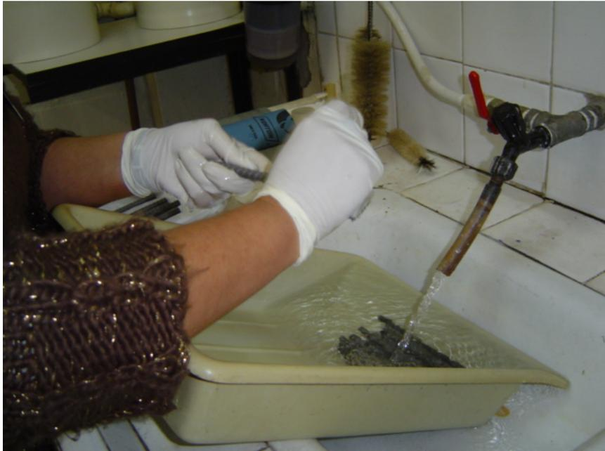
**Figura 6.14 – Fotografia da escovação das armaduras comuns para a remoção dos óxidos.**
