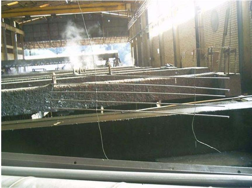
**Figura 6.3 – Remoção das armaduras do banho de fluxagem.**
