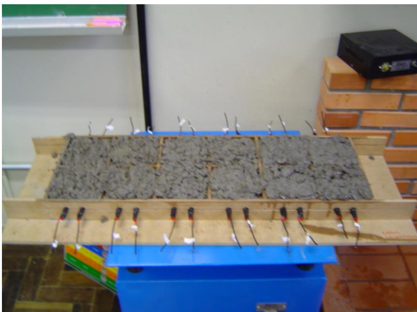
**Figura 6.19 – Fotografia dos concretos lançados na fôrma com adensamento em mesa vibratória.**
