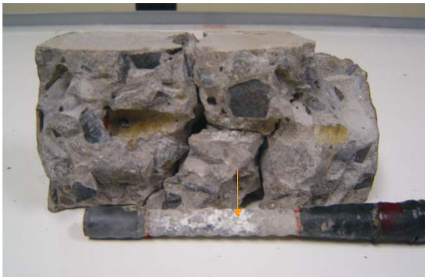
**Figura 7.25 – Fotografia do corpo-de-prova com concreto de cimento CPIV e relação água/cimento 0,4 com armadura galvanizada após os ciclos de corrosão.**
