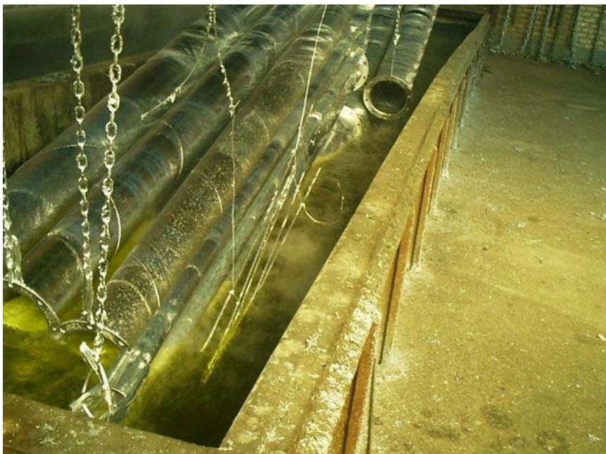
**Figura 6.5 – Imersão das armaduras na cuba de resfriamento e passivação.**
