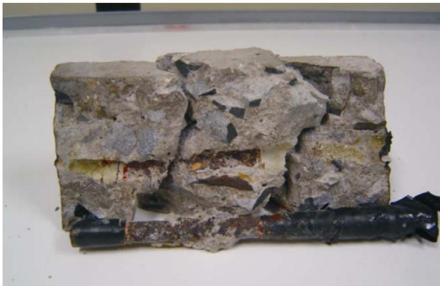
**Figura 7.32 – Fotografia do corpo-de-prova com concreto de cimento CII F e relação água/cimento 0,5 com armadura comum após os ciclos de corrosão.**
