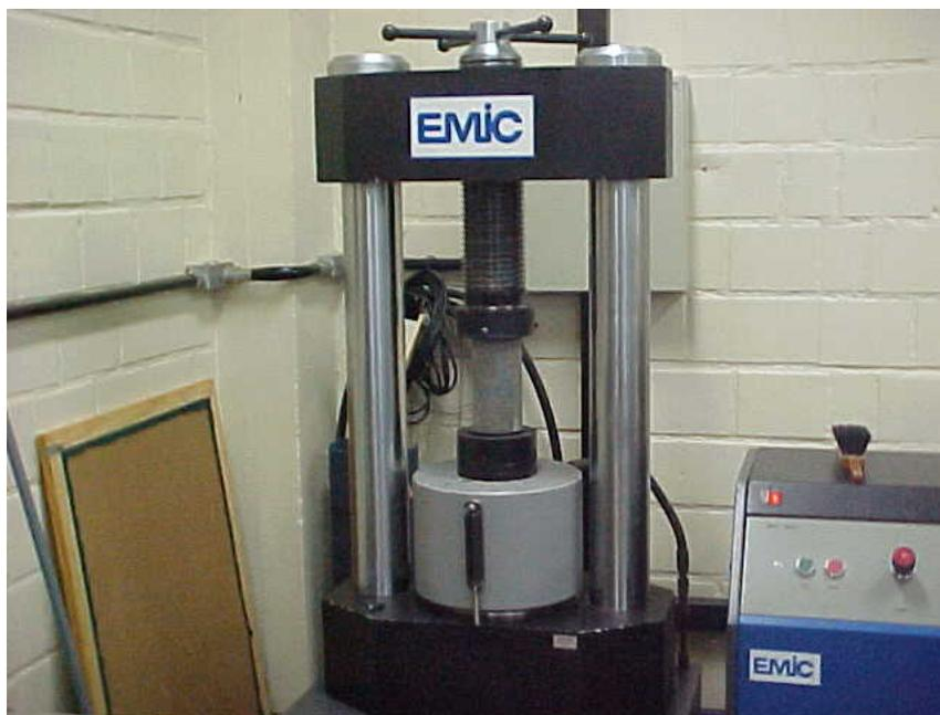
**Figura 6.12 – Máquina utilizada para a realização ensaios de resistência a compressão dos concretos.**
