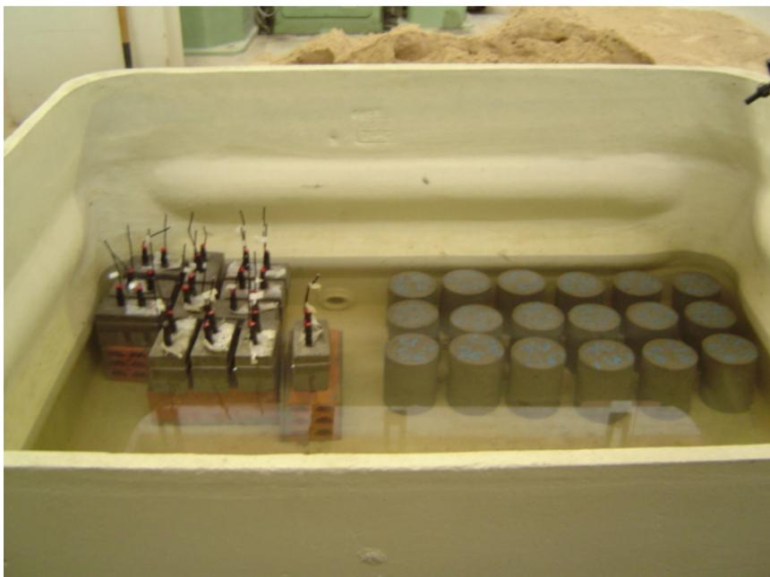
**Figura 6.20 – Fotografia da cura dos concretos em tanque de água fria.**
