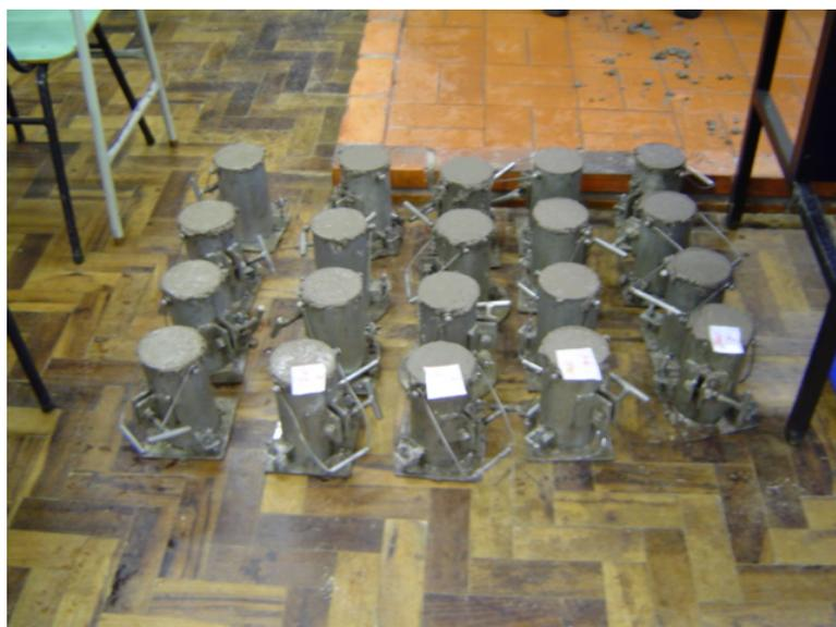
Figura 6.11 – Corpos-de-prova cilíndricos para ensaios de compressão e absorção de água.
