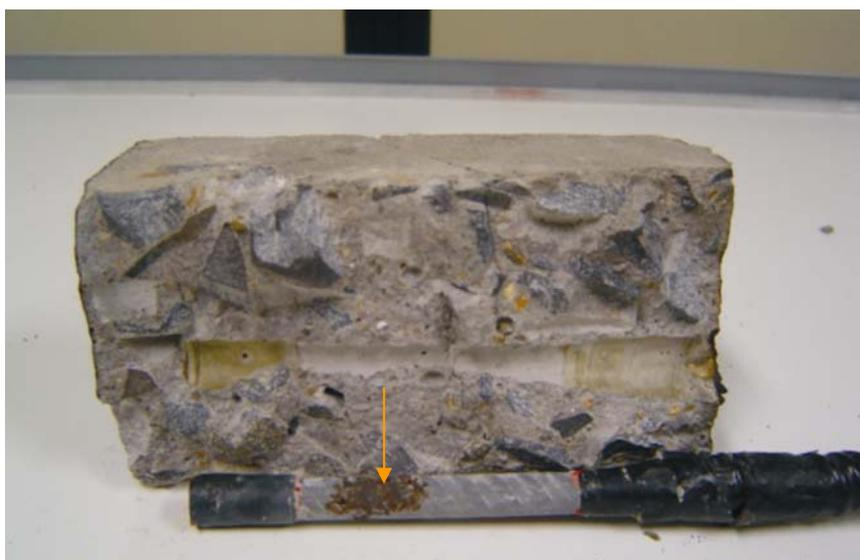
**Figura 7.26 – Fotografia do corpo-de-prova com concreto de cimento CPIV e relação água/cimento 0,5 com armadura comum após os ciclos de corrosão.**
