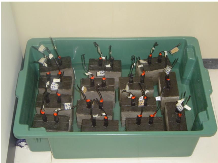
**Figura 6.24 – Fotografia dos corpos-de-prova na etapa de imersão em solução de cloreto de sódio 5% vol. em água.**
