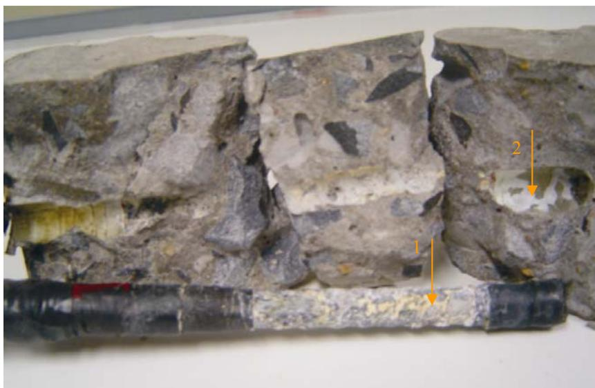
**Figura 7.31 – Fotografia do corpo-de-prova com concreto de cimento CII F e relação água/cimento 0,4 com armadura galvanizada após os ciclos de corrosão.**
