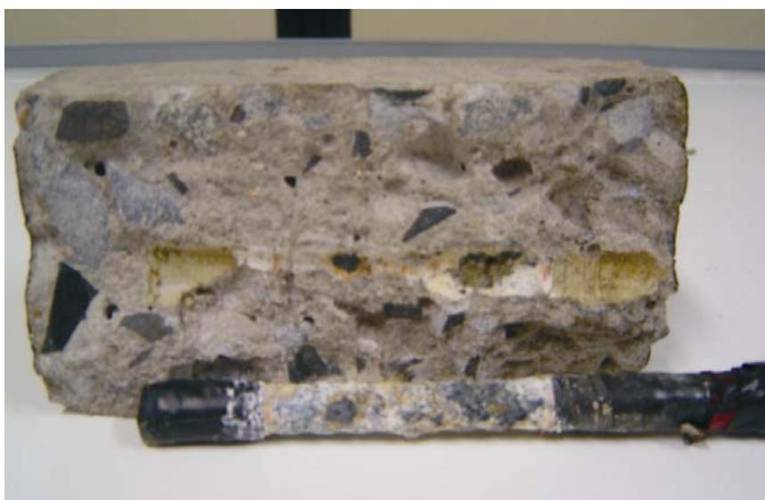
**Figura 7.36 – Fotografia do corpo-de-prova com concreto de cimento CII F e relação água/cimento 0,6 com armadura galvanizada após os ciclos de corrosão.**
