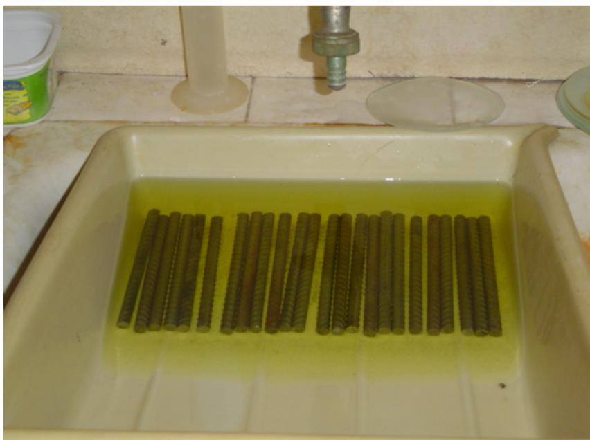
**Figura 6.13 – Fotografia das armaduras comuns imersas na solução preparada para a remoção dos óxidos superficiais.**
