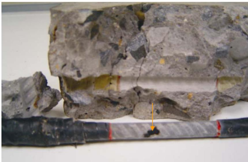
**Figura 7.24 – Fotografia do corpo-de-prova com concreto de cimento CPIV e relação água/cimento 0,4 com armadura comum após os ciclos de corrosão.**
