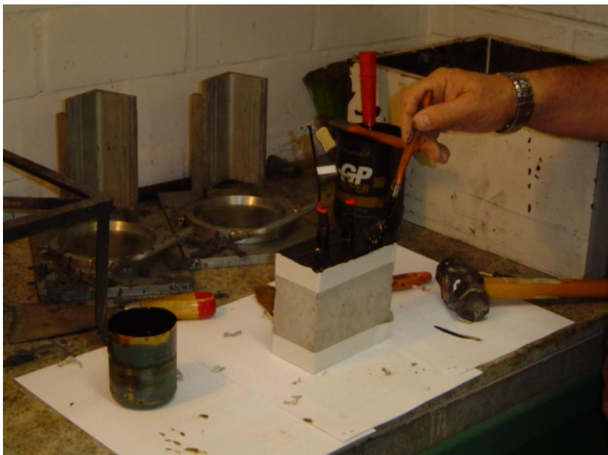
Figura 6.21 – Fotografia ilustrando a aplicação da tinta anticorrosiva nas faces superior e inferior dos corpos-de-prova.
