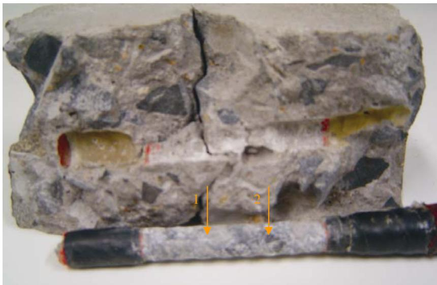
**Figura 7.27 – Fotografia do corpo-de-prova com concreto de cimento CPIV e relação água/cimento 0,5 com armadura galvanizada após os ciclos de corrosão.**
