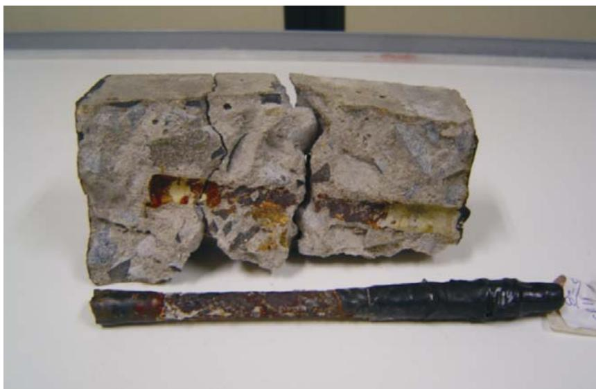
**Figura 7.34 – Fotografia do corpo-de-prova com concreto de cimento CII F e relação água/cimento 0,6 com armadura comum após os ciclos de corrosão.**
