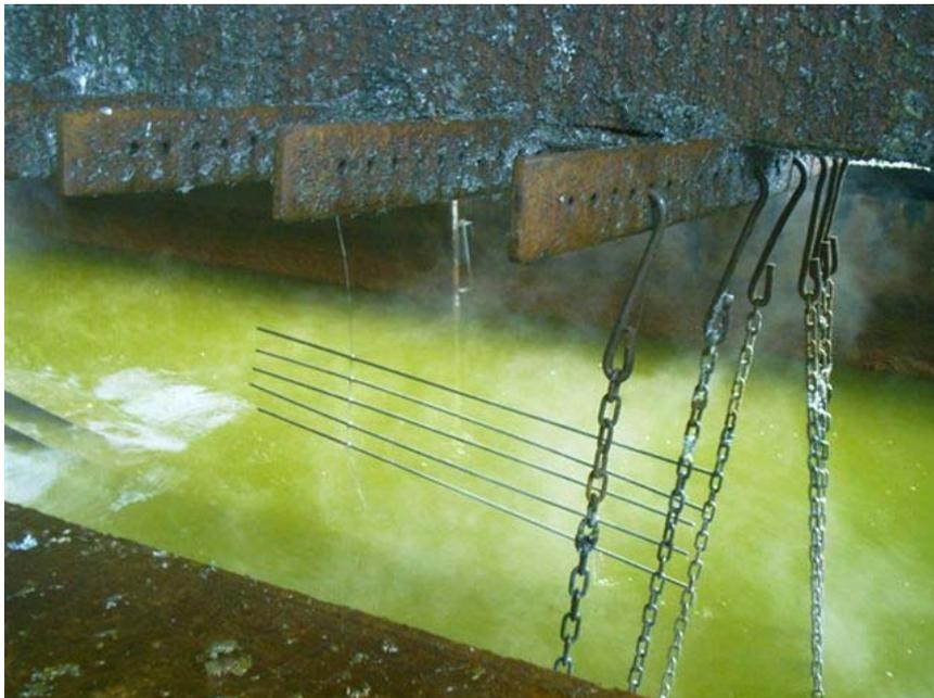
**Figura 6.2 – Decapagem ácida das armaduras de aço.**
