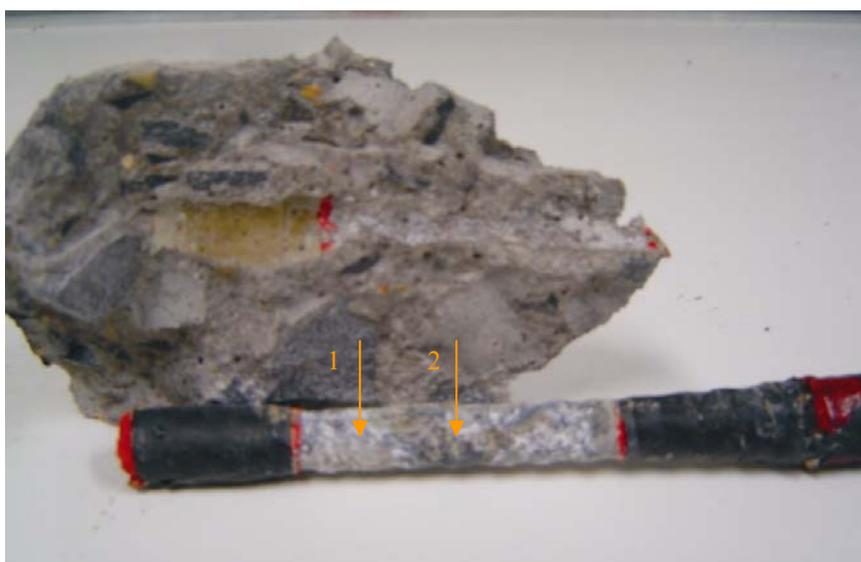
**Figura 7.29 – Fotografia do corpo-de-prova com concreto de cimento CPIV e relação água/cimento 0,6 com armadura galvanizada após os ciclos de corrosão.**
