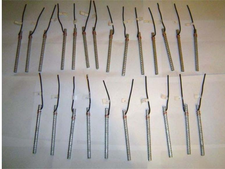
**Figura 6.16 – Fotografia dos fios flexíveis de cobre conectados nas armaduras para as medições eletroquímicas.**
