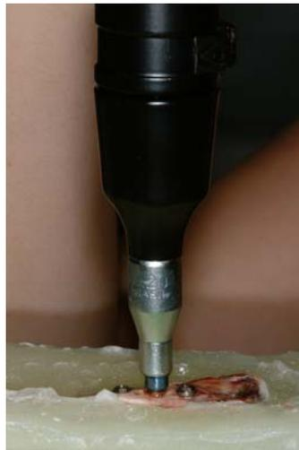
Figura 17- Aplicação de torque de remoção nos implantes
