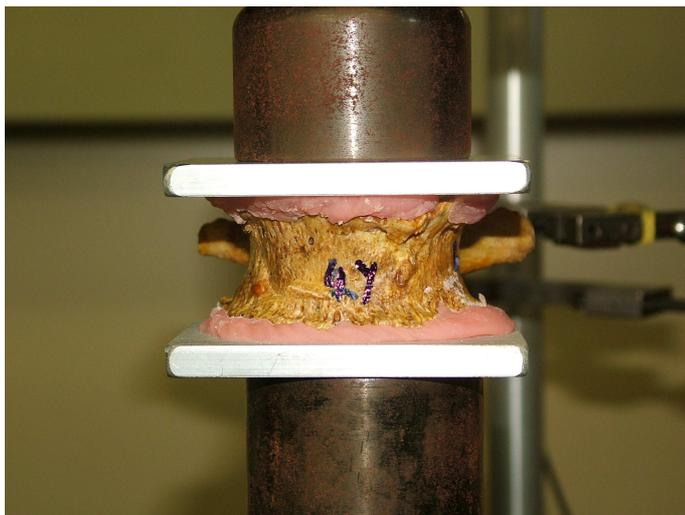
Figura 40 - Acoplamento do corpo vertebral na máquina de ensaio
