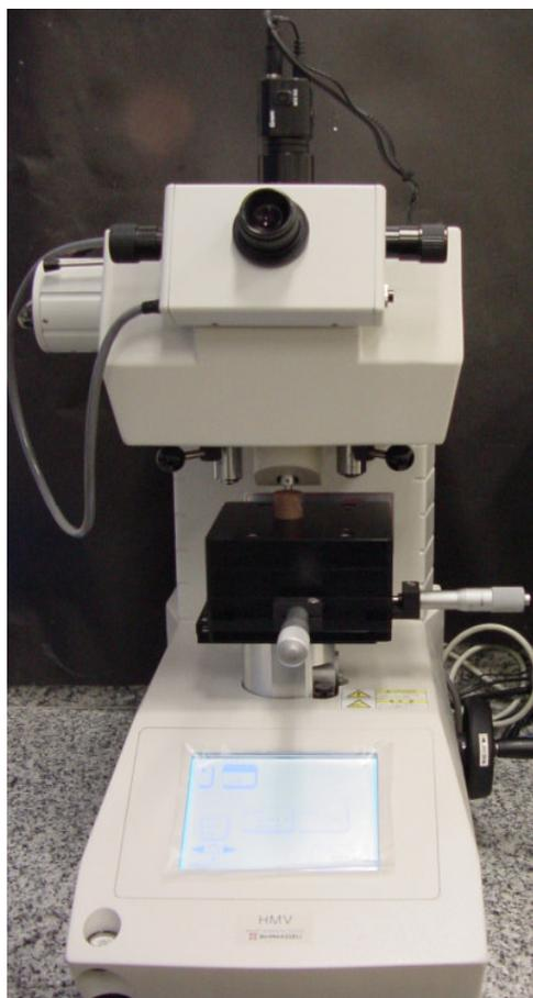
**FIGURA 16** - Microdurômetro HMV
