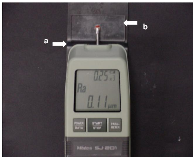
**FIGURA 13** - Rugosímetro SJ-201 posicionado sobre uma base metálica (a), fazendo a leitura da rugosidade Ra ( $\mu\text{m}$ ) da amostra colocada no orifício central da placa acrílica transparente (b).
