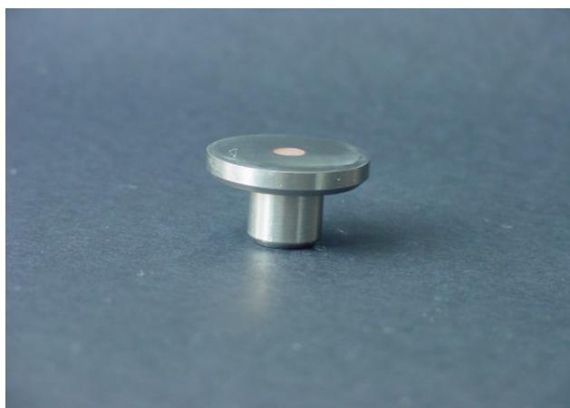
**FIGURA 8** - Corpo-de-prova desgastado na altura do adaptador (5 mm).
