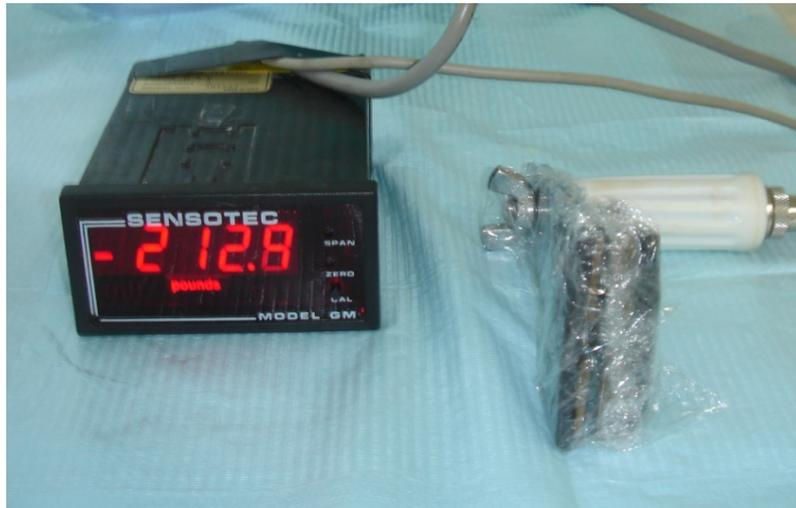
Figura 14: Aparelho para Medição da Força de mordida
