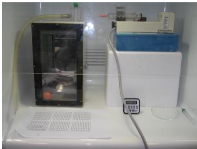
Figura 4: Modelo de câmara vedada para experimentos com. A bomba de infusão acoplada permite gotejo constante da droga. Na parte anterior visualiza-se dispositivo que permite a entrada de ar. A evacuação do agente é realizada através de vácuo-sucção.
