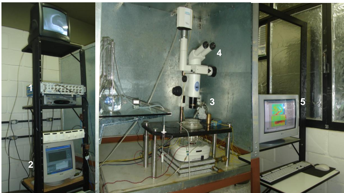
Figura 13 Equipamentos utilizados para obtenção do registro simultâneo do PE e do IOS durante as AE's em fatias do hipocampo. 1- Amplificador CYBERAMP 380 para amplificação do sinal elétrico; 2- "Setup" para registro do potencial elétrico extracelular; 3- Pré-amplificador (Headstage modelo AI 402 x 50) para aquisição dos sinais e foi interligada a um amplificador biológico; 4- Microscópio
