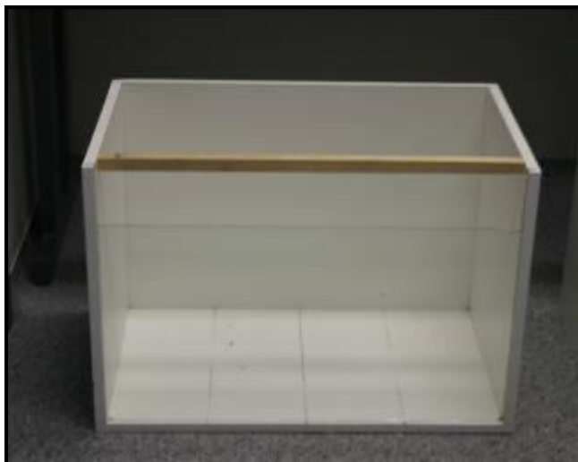
Figura 3 Campo Aberto. Foto do aparato utilizado para avaliação da atividade locomotora e o comportamento exploratório dos animais.
