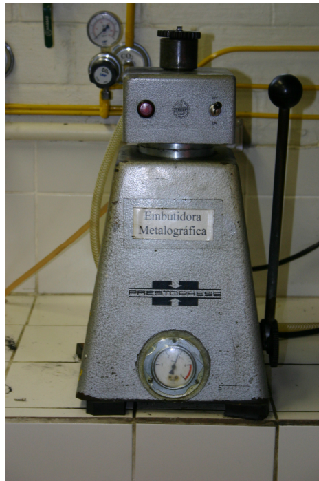
Figura 3: Embutidora Metalográfica Prestopress
