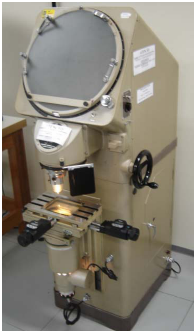
Figura 9: Imagem do Projetor de perfil Nikon modelo v.16, número de série 36914.
