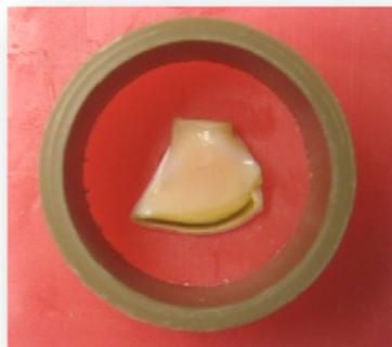
**Figura 6** – Anel de PVC posicionado sobre a lâmina de cera.
