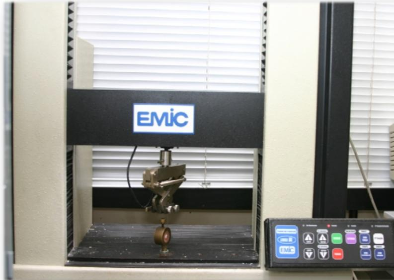
**Figura 14** – Máquina de ensaio mecânico Emic DL2000<sup>®</sup>.
