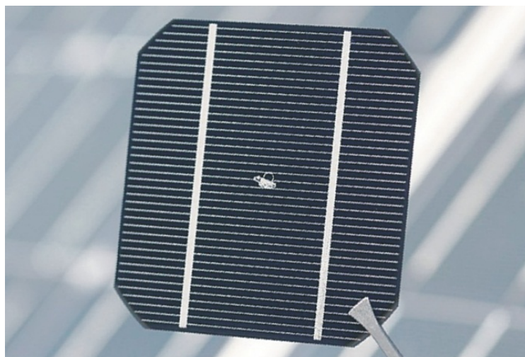
Figura 3.5. Célula solar desenvolvida, onde se visualiza a forma da malha de metalização.
