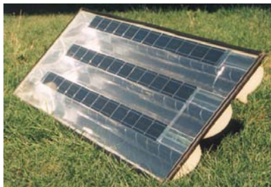
Figura 2.4. Módulo fotovoltaico concentrador estático com refletor especular e com células solares bifaciais [7].
