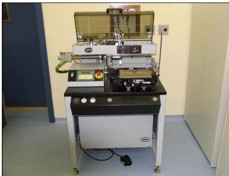
Figura 3.4. Equipamento utilizado para realização do processo de serigrafia.
