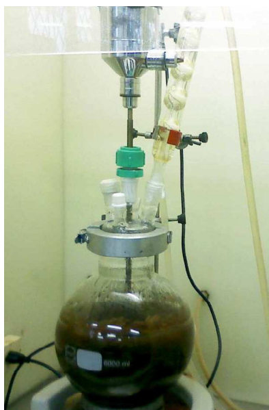
Figura 4.11. Descontaminação da madeira tratada com CCA em batelada (reator de vidro) e aquecimento em chapa elétrica.
