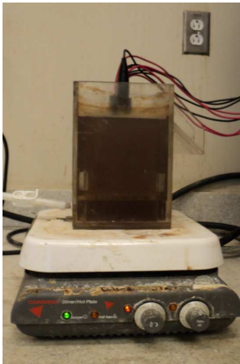
Figura 4.7. Cuba eletrolítica em acrílico utilizada para eletrorrecuperação de cobre e agitador magnético.
