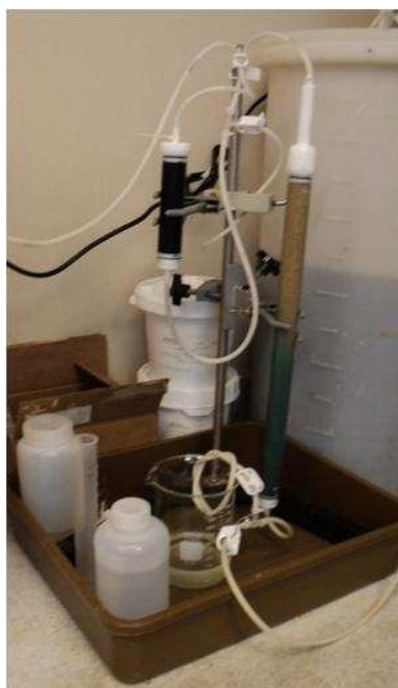
Figura 4.10 Sistema montado para recuperação de Cr e de Cu por troca iônica com as resinas Amberlite IR120 (19 x 210mm) e Dowex 4195 (19 x 650mm).
