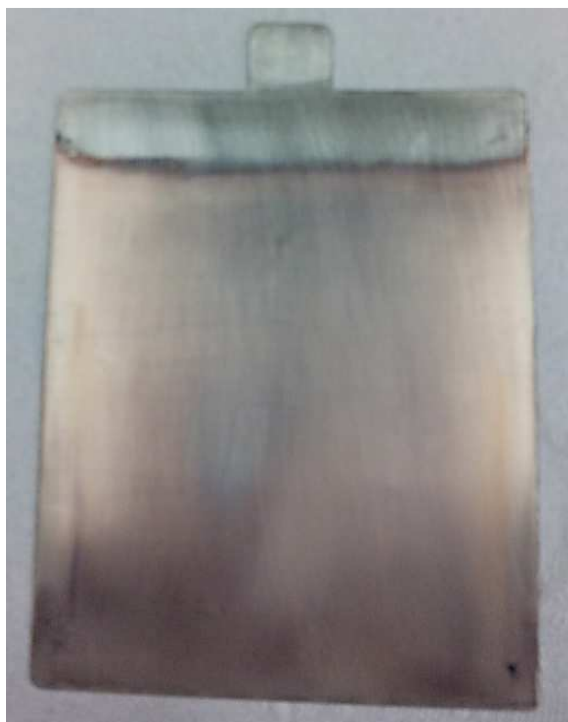
Figura 5.18. Eletrodo recoberto por Cu após eletrorrecuperação do efluente da madeira tratada com CCA em 5A por 90 min.
