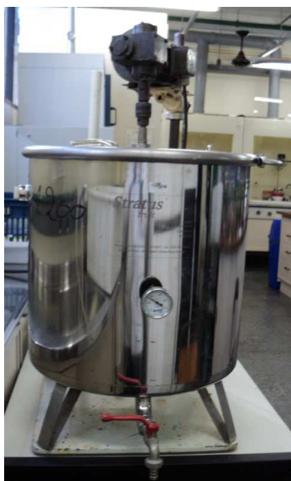
Figura 4.13. Tanque de aço inoxidável utilizado para descontaminação da madeira tratada com CCA em escala piloto (4,5 kg de madeira para 30 L de solução extratora).
