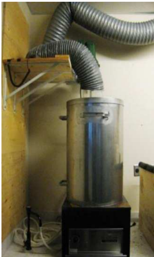
Figura 4.3. Tanque de aço inoxidável e chapa elétrica utilizados para descontaminação em escala piloto (12 kg de madeira para 80 L de solução extratora).
