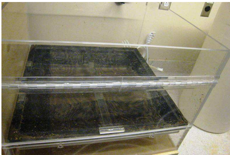
Figura 4.4. Recipiente em acrílico utilizado para retirar o excesso de água da madeira após cada ciclo de extração e lavagem.
