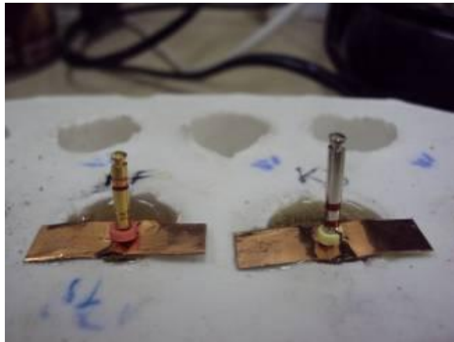
Figura 2 - Embutimento das limas em Resina
