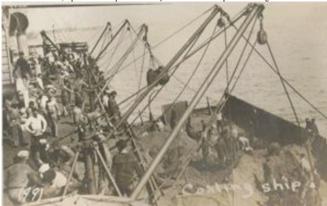
Figura 22 – USS Pueblo tomando carvão de uma barça durante a Primeira Guerra Mundial. No detalhe, a proximidade que a embarcação ficava do navio para descarregar o carvão
