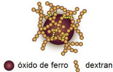
Figura 3.7. Representação de uma nanopartícula de óxido de ferro em sistema núcleo-casca (do inglês, core-shell ), composto de um núcleo de óxido de ferro e um revestimento de dextran [adaptado de 38].
