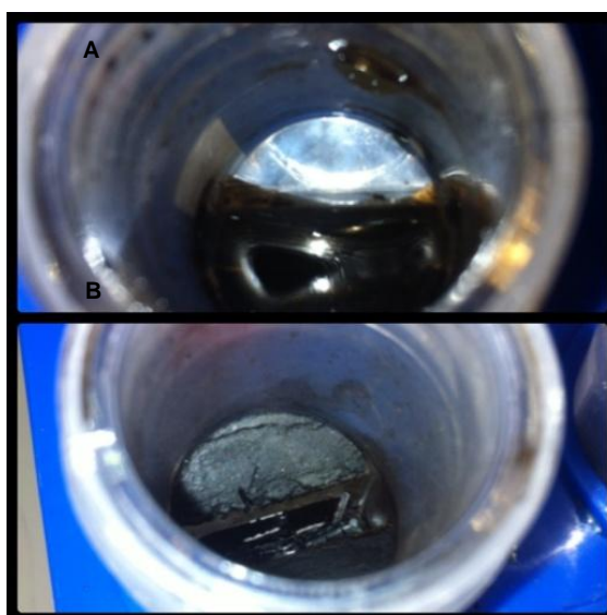
Figura 5.1. Imagem dos tubos falcon com as nanopartículas. Formação de duas fases na etapa final da síntese: uma fase líquida e uma fase sólida da síntese S9 (A); uma fase sólida para a síntese S10 (B).
