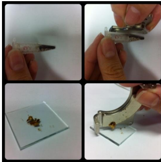
Figura 5.18. Fotos da amostra liofilizada da síntese S4 mediante um magneto.
