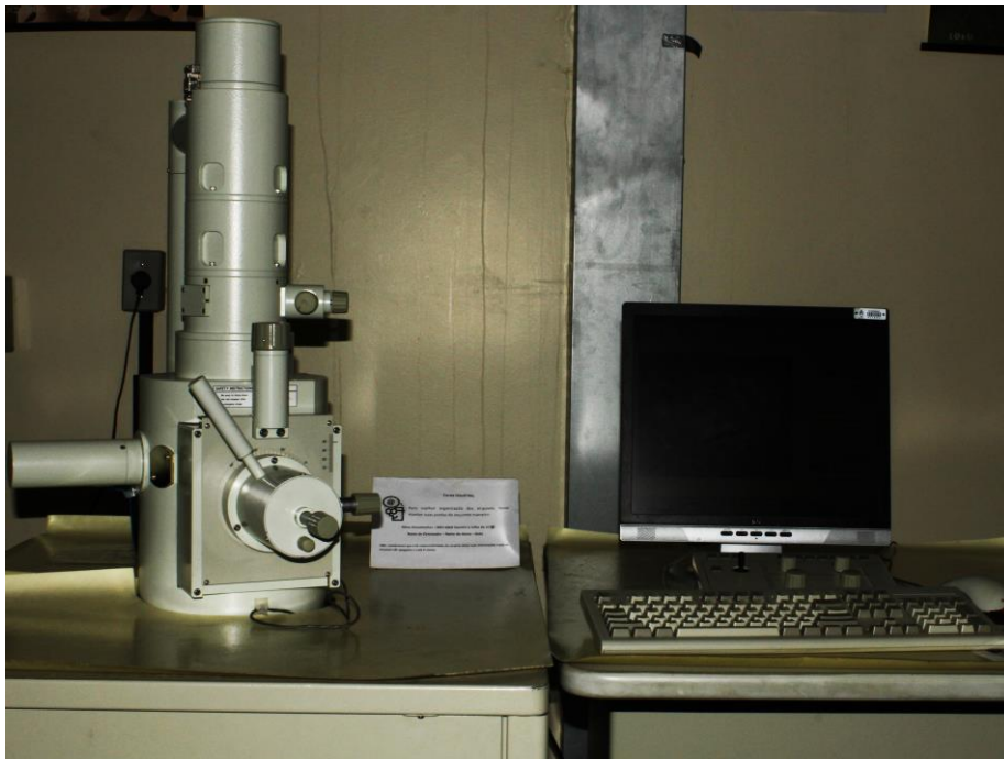
Figura 17- Microscópio eletrônica de varredura JEOL JSM-6060
