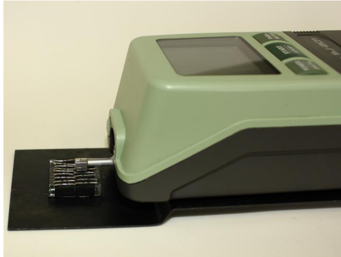
Figura 20- Agulha do rugosímetro promovendo a leitura dos segmentos.
