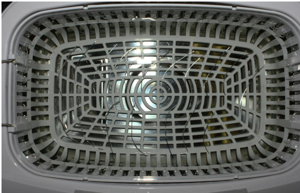
Figura 14- Segmentos submersos em solução de água destilada e detergente enzimático.
