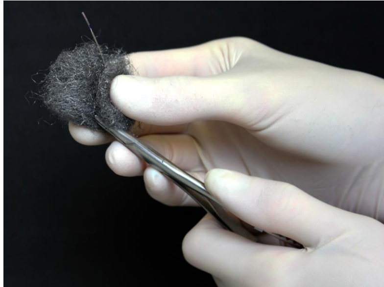
Figura 15- Fricção digital de esponja de aço Bombril® com velocidade e pressão digital constantes.
