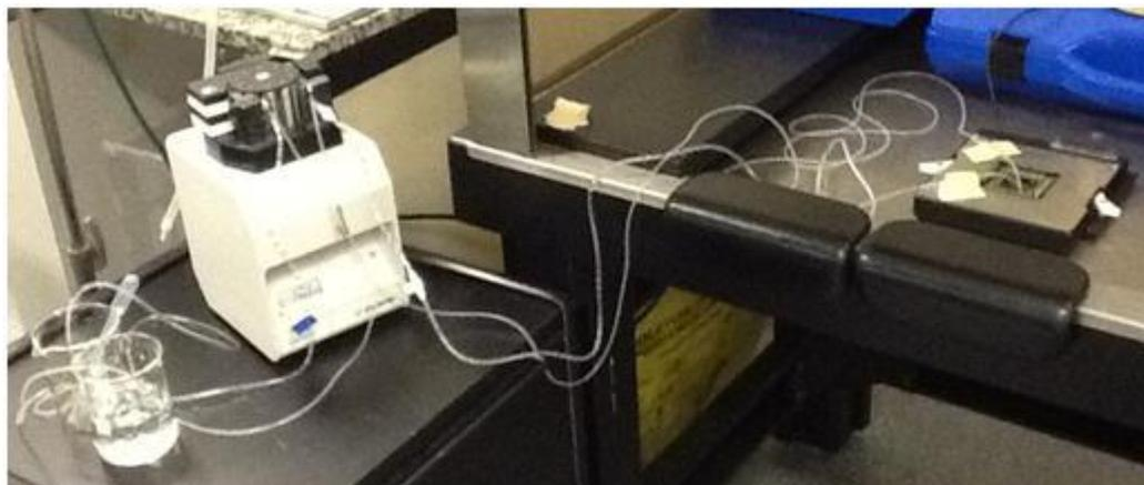
Figura 5.19 Montagem experimental da bomba de perfusão com o sistema MEA.
