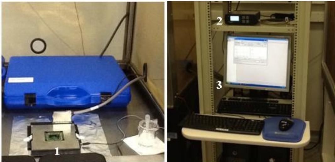
Figura 4.2 *Setup* do sistema MEA: (1) pré-amplificador MEA1060-Inv; (2) controlador de temperatura; (3) microcomputador equipado com conversor de sinais analógico/digital (MC\_Card) e softwares TCX-Control, MC\_Rack e MC\_DataTool.
