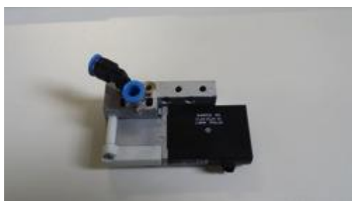
Figura 81 - Válvula solenoide de emergência.
