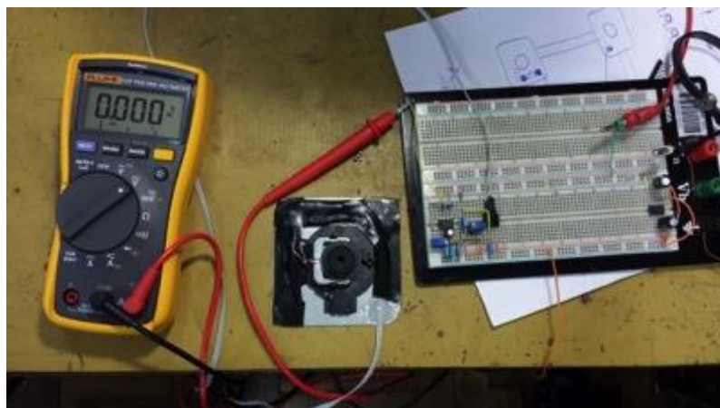
Figura 61 - Testes de calibração células de carga em protoboard, sem carga.
