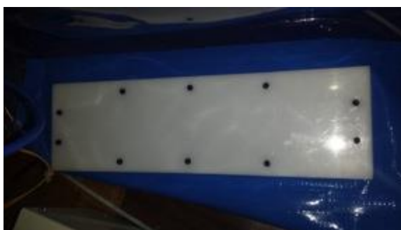
Figura 79 - Interface para passagem de instrumentos.
