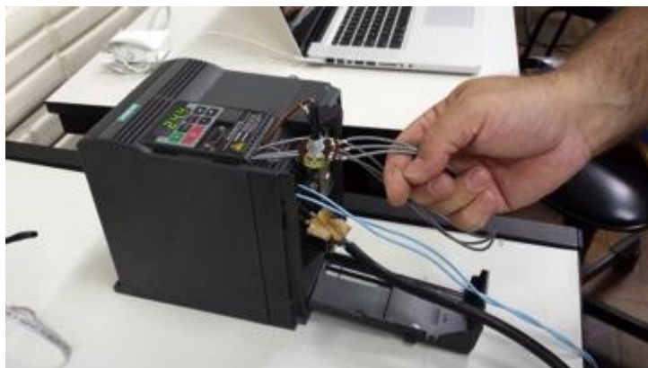
Figura 28 - Controle do inversor de frequência analógico através de potenciômetro.
