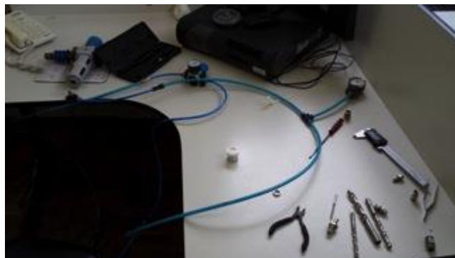
Figura 93 - Circuito pneumático de testes de PVC transparente.
