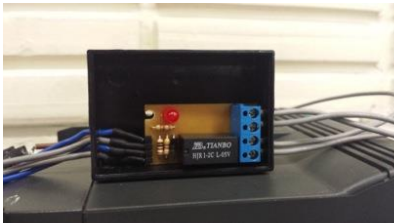
Figura 84 - Circuito de Emergência.
