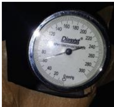
Figura 95 - Manômetro para testes em PVC transparente em 60 mmHg.
