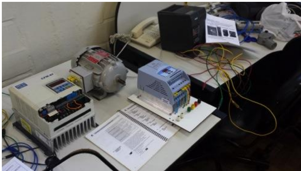
Figura 26 - Bancada de testes de inversores de frequência e motores.
