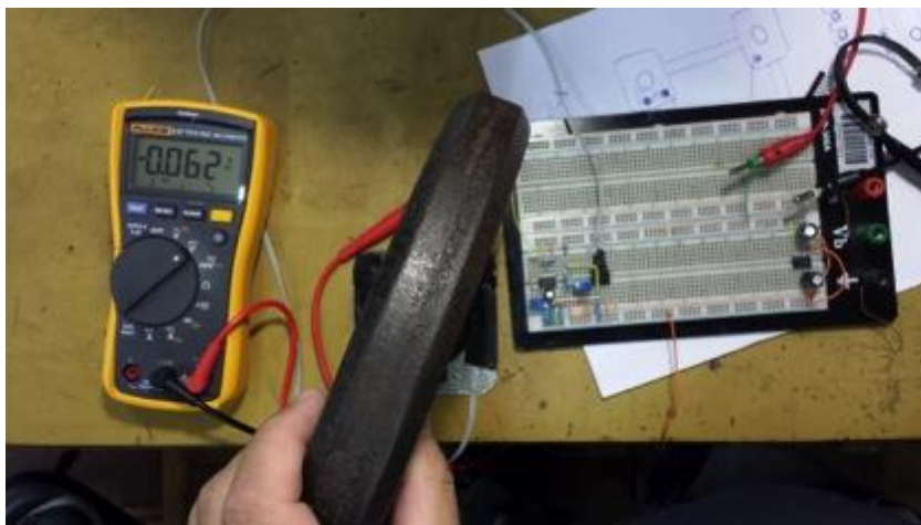
Figura 62 - Ajuste do ganho células de carga em protoboard, com carga conhecida.
