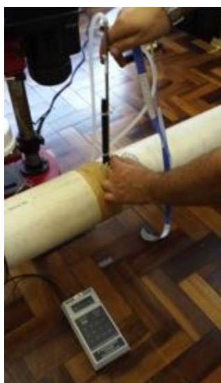
Figura 90 - Colocação do tubo de pitot no duto.
