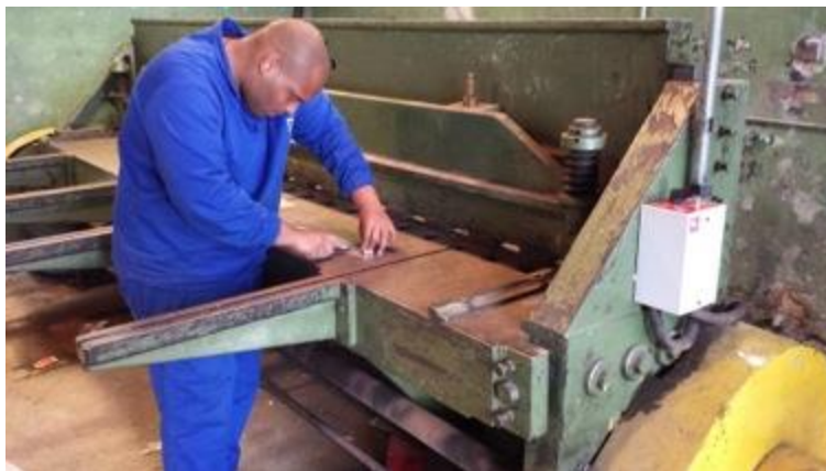
Figura 57 - Confeção placas de metal para apoio das células de carga na Divisão de Obras da PUCRS.
