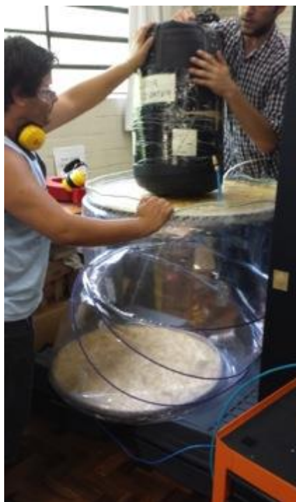
Figura 96 - Teste com carga de 54kg no PVC transparente.
