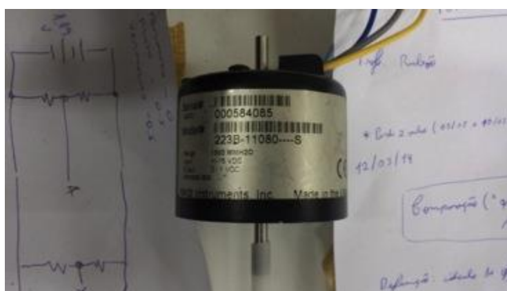
Figura 29 - Sensor de pressão MKS Instruments Inc. Modelo 223B-11080.
