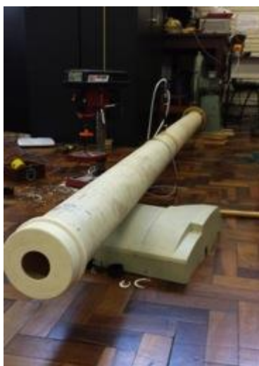
Figura 89 - Duto acoplado ao soprador.
