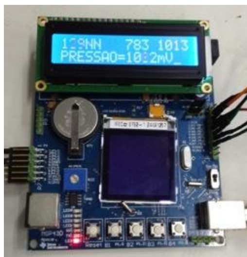
Figura 106 - Display com informações durante teste com carga.
