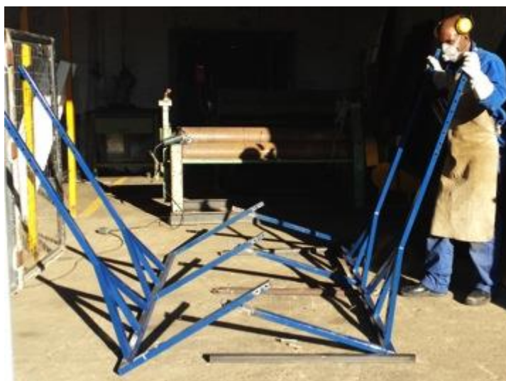
Figura 55 - Encaixe estrutura metálica versão final.
