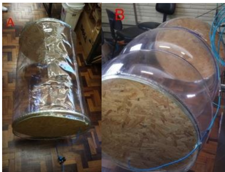
Figura 94 - Testes com PVC transparente A: pressão ambiente; B: pressão = 60 mmHg.
