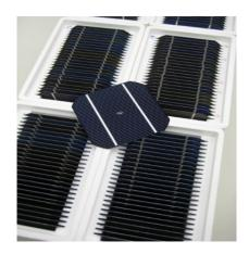
Figura 4.5. Células solares pseudo-quadradas de 80 mm x 80 mm [61].
